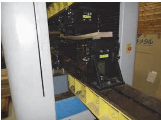
写真 2.9-1 ラミナ曲げ試験状況
