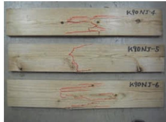
写真 2.9-8 M90NJ ラミナ破壊状況例
