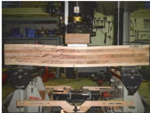
図 2.5-5 荷重－変位曲線と破壊後の様子（7層強軸）
