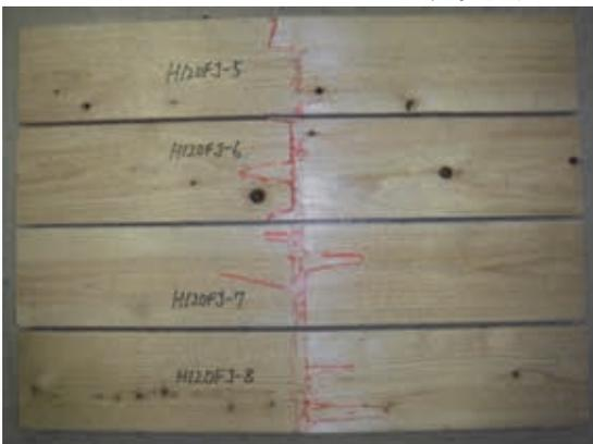
写真 2.9-9 M120FJ ラミナ破壊状況例
