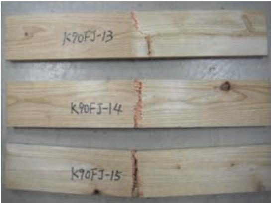
写真 2.9-7 M90FJ ラミナ破壊状況例
