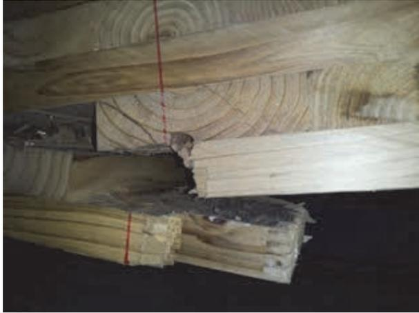
写真 2.3-7 荷重レベル 80%破壊 FJ 破壊状況詳細
