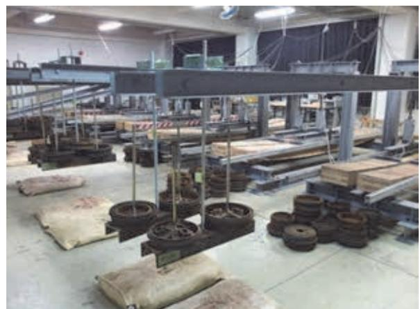
写真 2.3-4 弱軸試験体の錘の状況
