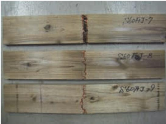
写真 2.9-5 M60FJ ラミナ破壊状況例
