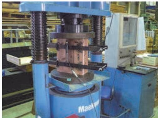
写真 2.7.1-1 圧縮試験の様子
