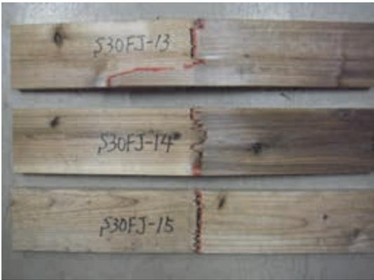
写真 2.9-3 M30FJ ラミナ破壊状況例
