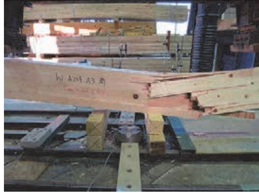
写真 2.4-3 外層ヒノキ・内層スギの試験体の破壊の様子の一例
