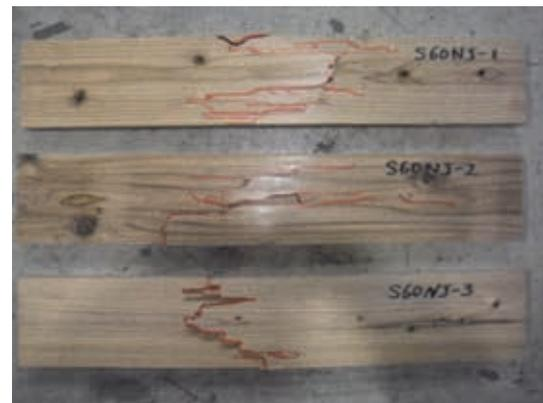
写真 2.9-6 M60NJ ラミナ破壊状況例
