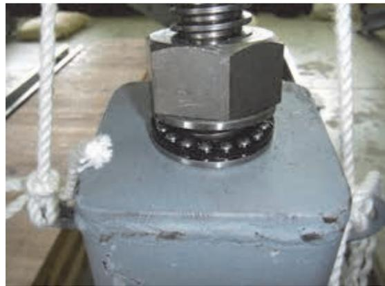
写真 2.3-2 加力点軸ネジ部
