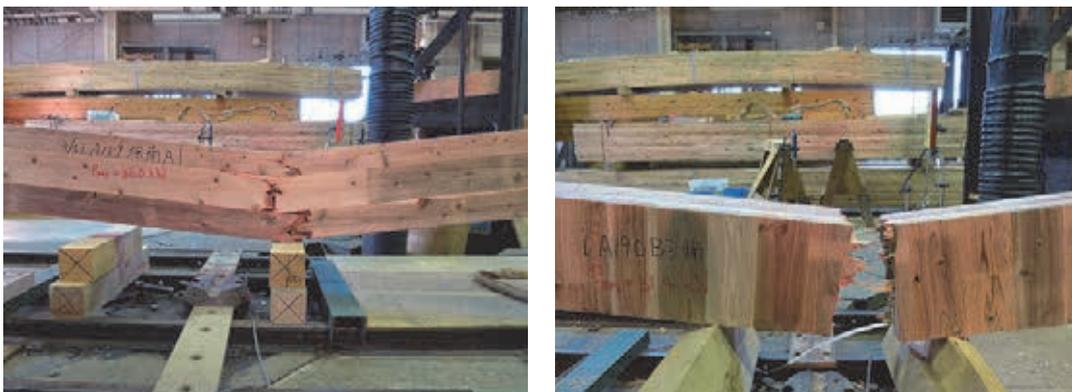
写真 2.4-2 全層スギの試験体の破壊の様子の一例
