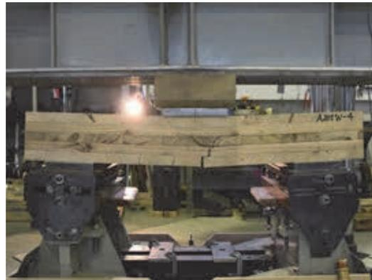
図 2.5-4 荷重－変位曲線と破壊後の様子（5層弱軸）
