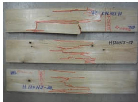
写真 2.9-10 M120NJ ラミナ破壊状況例
