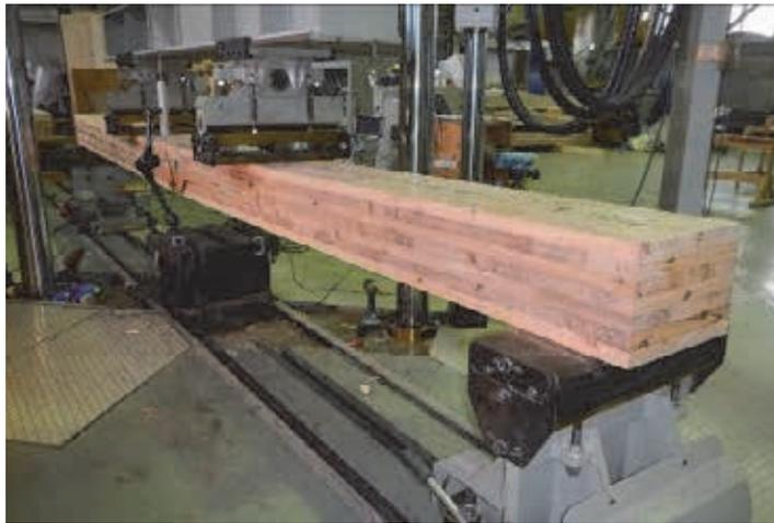
写真 2.2-1 面外曲げ試験の様子
