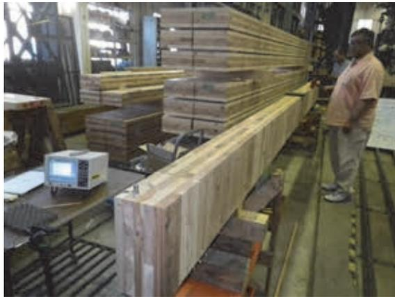
写真 8-1 T.G.H.法による固有振動数の測定の様子
