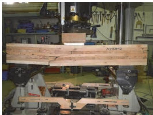
図 2.5-6 荷重－変位曲線と破壊後の様子（7層弱軸）
