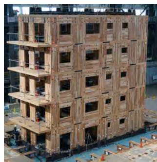
CLT パネルを用いた建築物の構造性能検証震動台実験（E-ディフェンス）
