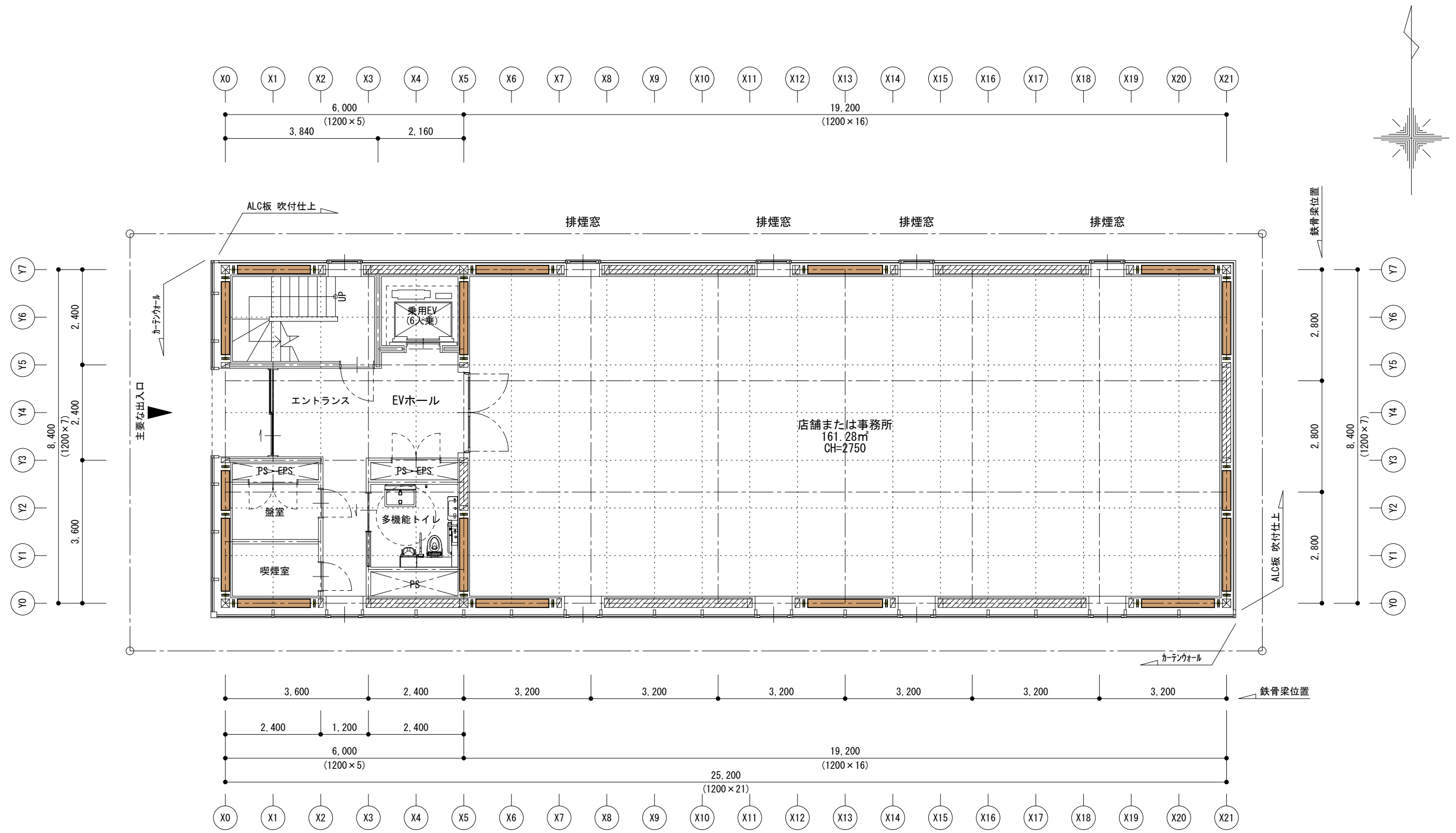
1階平面図 S:1/100 グリッド: 1200×1200 CLT壁パネル t=210 (S90-5-7)
