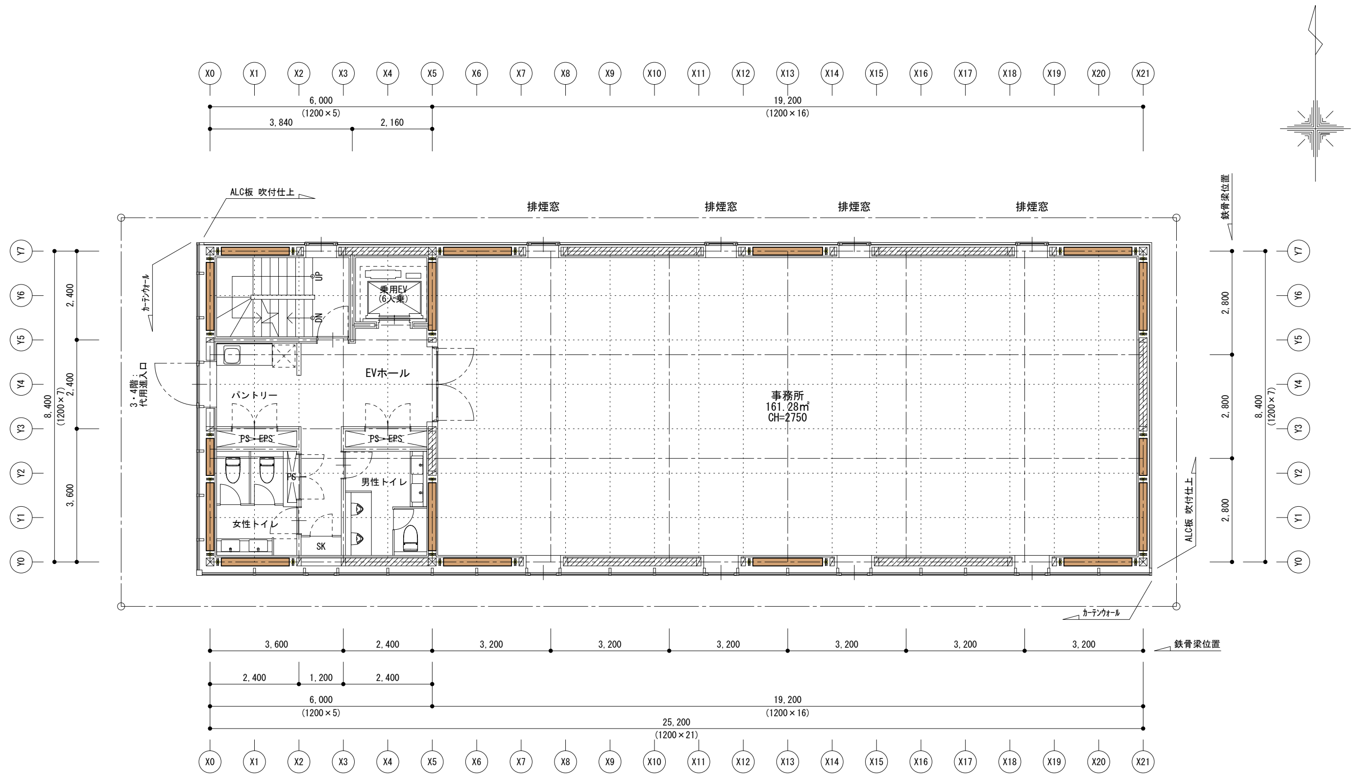
基準階平面図 S:1/100 グリッド: 1200×1200 CLT壁パネル t=210 (S90-5-7)
