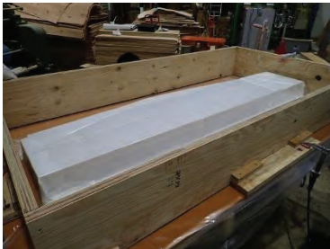
No.5(真空プレス)試験体のプレス状況(表面白色は試験体に被せた不織布)
