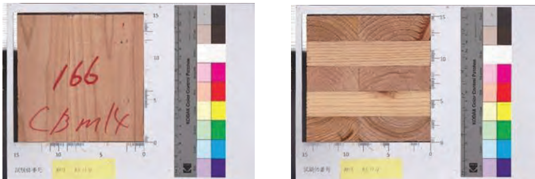
写真 4.8-1 キュービック供試体の撮影例 (左: 板目面、右: 強軸側木口面)
