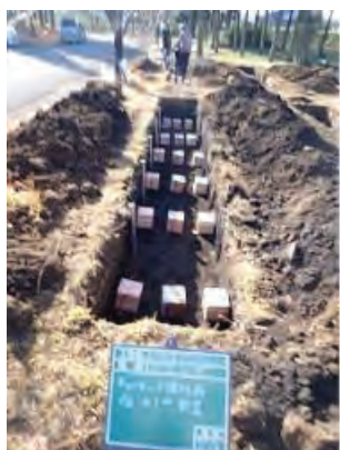
写真 4. 9-23 キュービック供試体 GL-0.1m (かぶり厚)
