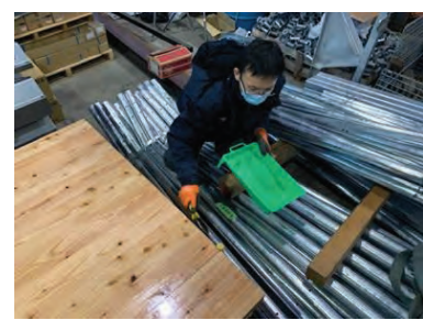
写真 1.3-5 ポリウレタン系樹脂塗料の塗布
