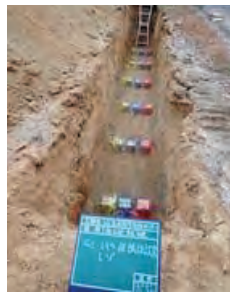
写真 4.9-18 キュービック供試体 GL-1.5m (キュービック供試体底面)
