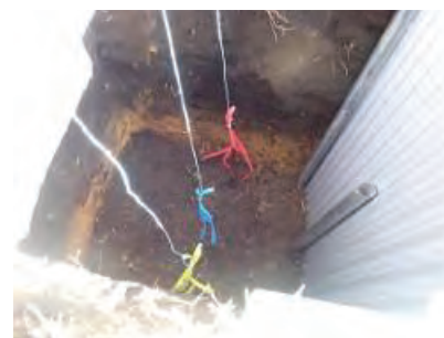
写真 4. 9-25 キュービック供試体 GL-1.5m (キュービック供試体底面)
