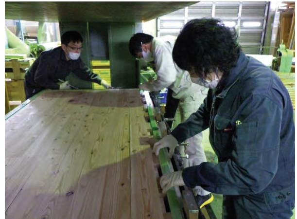
写真 6. 1-5 内層ラミナを一部省略した CLT の製造風景
