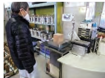
写真4.9-3 キュービック供試体質量測定
