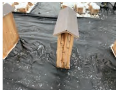
写真 4.9-14 ボード供試体屋根設置
