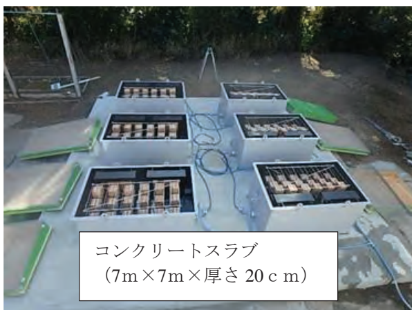
図 4.11-2 コンクリートスラブ上に水槽を置いた状況
