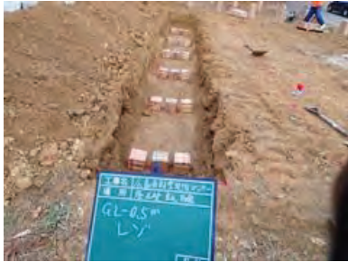
写真 4.9-17 キュービック供試体 GL-0.5m (キュービック供試体底面)
