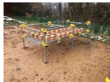
写真 4.9-21 キュービック供試体 GL+0.5m
