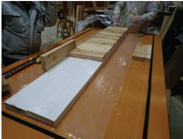
No.5(真空プレス)試験体の製作状況
