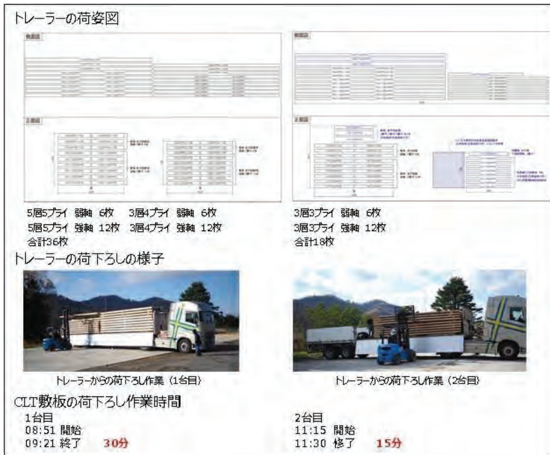
図 5.3-5 CLT 敷板の荷下ろし作業
