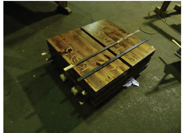
写真 6.2-2 塗布処理後の試験体
