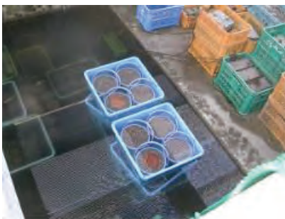
写真 4. 10-4 常時海中エリア設置
