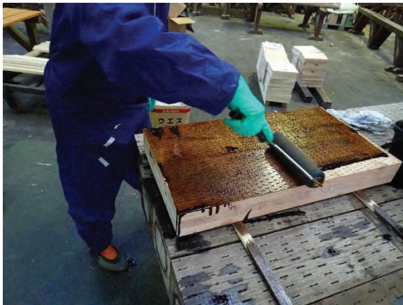
写真 6.2-1 クレオソート油による塗布処理
