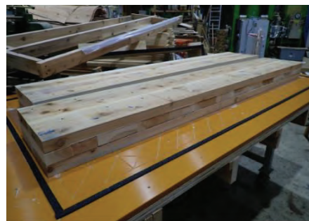
写真 1.6-1 ラミナのプレーナー加工を省略して製造したC材利用のCLT
