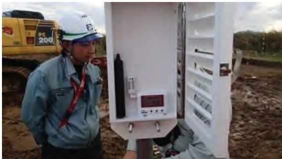
(g) 百葉箱の内側の状況 (水位計バロメータ, 温度・湿度計)
