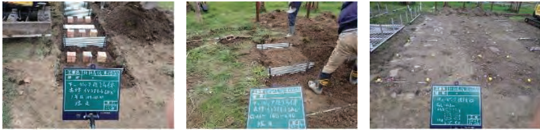
写真 4.9-9 キュービック供試体 GL-0.1 m (被り厚)
