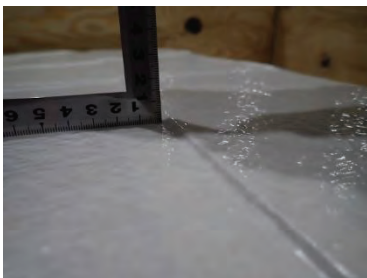
No.5(真空プレス)試験体の上面に現れた凹凸(約3 mm)
