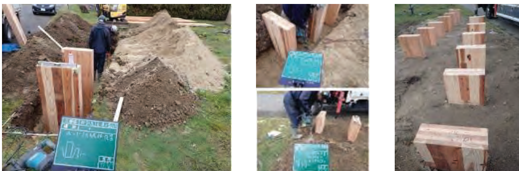
写真 4.9-8 ボード供試体設置（地表～0.5 m：盛土、0.5～1.0 m）
