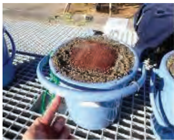
写真 1.1-4 海水環境をモデル化した供試体の設置状況
