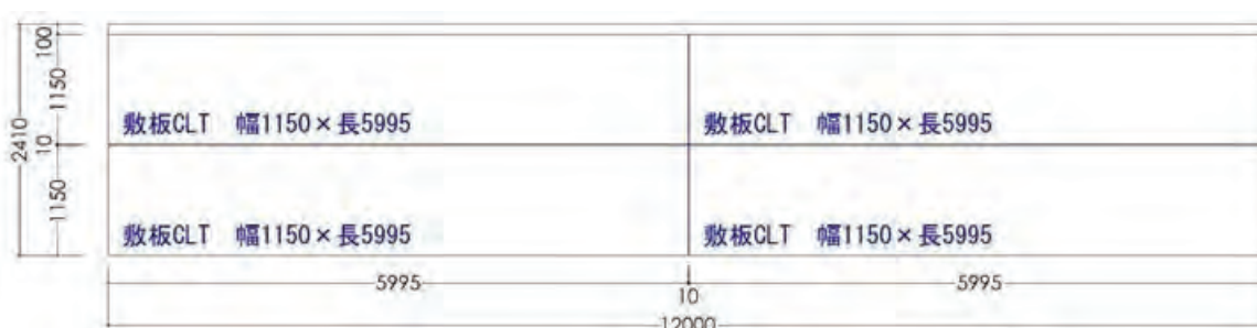
図 5.3-3 CLTMB から CLT 敷板を製造する際の加工図 (mm)
