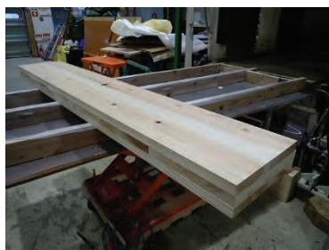
プレーナー加工したラミナで仕上げた CLT(コントロール用)の出来上がり(No.1.試験体)
