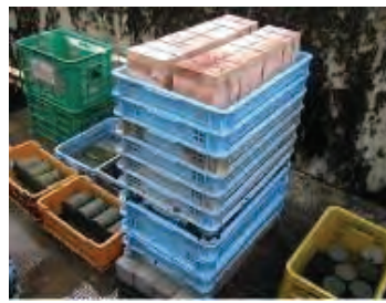
写真 1.1-4 海水環境をモデル化した供試体の設置状況
