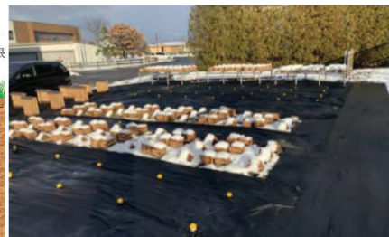
写真 1.1.3 地盤環境をモデル化した供試体の設置状況
