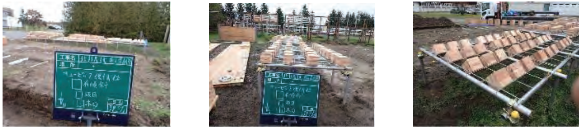
写真 4.9-12 キュービック供試体 GL+0.5 m (キュービック供試体底面)
