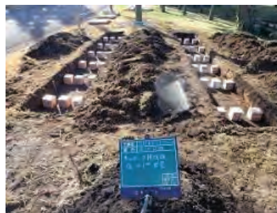
写真 4. 9-23 キュービック供試体 GL-0.1m (かぶり厚)
