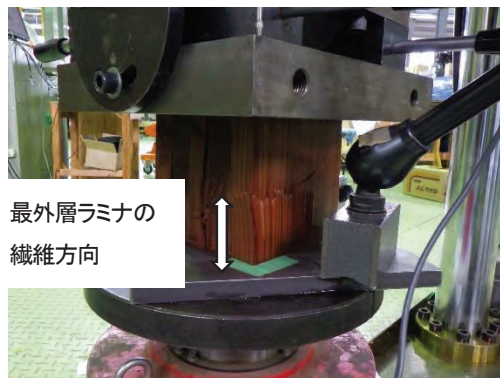
写真 4. 8-2 代表的な破壊性状の例（レゾルシノール、169 番）
