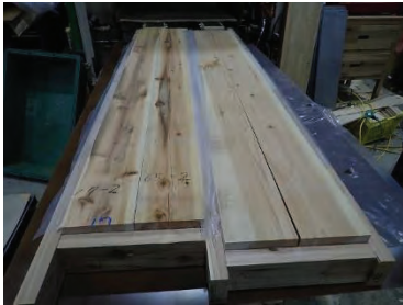
No.4 試験体(プレーナー加工なし)のプレス後の隙間
