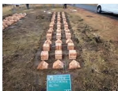
写真 4. 9-27 キュービック供試体 GL±0m
