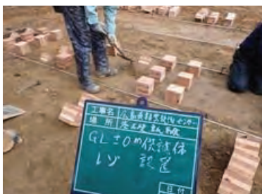
写真 4.9-20 キュービック供試体 GL±0m
