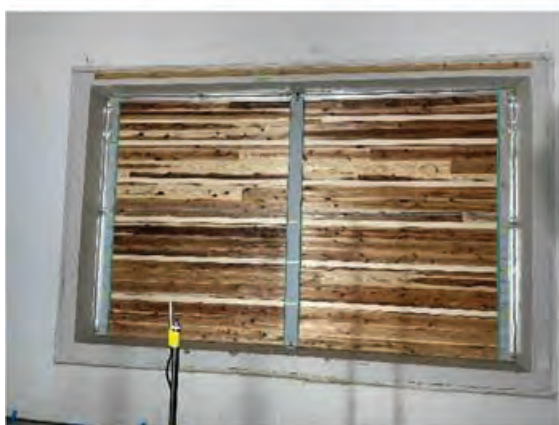
ケース 3 音源室試験状況
