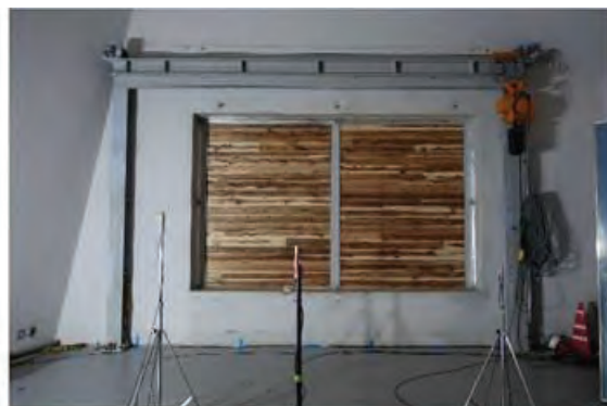
ケース 1 受音室試験状況
