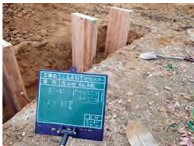
写真 4.9-18 キュービック供試体 GL-1.5m (キュービック供試体底面)
