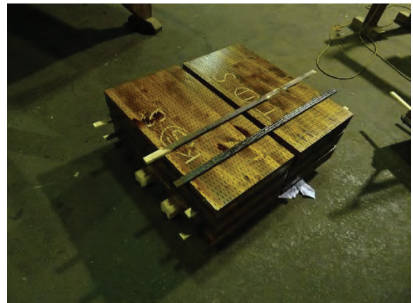
写真 1.7-2 塗布処理後の試験体
