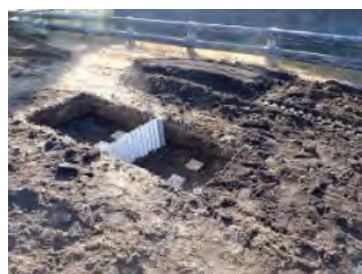
写真 4. 9-24 キュービック供試体 GL-0.5m (キュービック底面)
