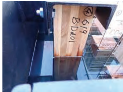
写真 4.11-9 供試体浸漬状況
