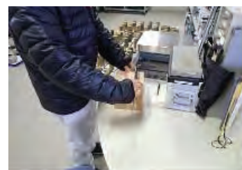
写真4.9-4 キュービック供試体寸法測定
