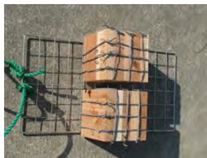
写真 4. 10-5 全面海水接触 (吊り下げWL-300 mm)
