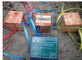
写真4.7-1 キュービック GL -1.5 m紐付け配置例
