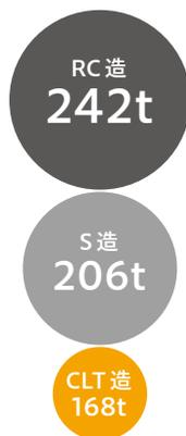
三重大学大学院の研究科グループの発表によると、CLT工法を用いた木造学校建築物(2階建て・延床面積407.2m<sup>2</sup>)の資材製造から施工までの建設プロセスから排出される温室効果ガスの量は442kg-CO<sub>2</sub>e/m<sup>3</sup>。また、建設時には168t-CO<sub>2</sub>e。これを同規模のRC造とS造でも算出して比較すると、RC造(同242t-CO<sub>2</sub>e)に対して30.6%削減、また、S造(同206t-CO<sub>2</sub>e)は18.5%削減できることが分かりました。
