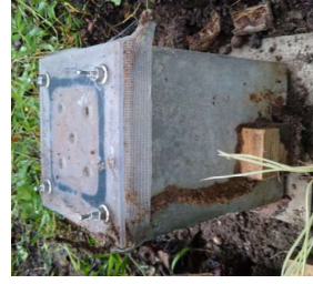
図17 フィールド試験の会所棟に構築されたイエシロアリによる外蟻道と空中蟻道
