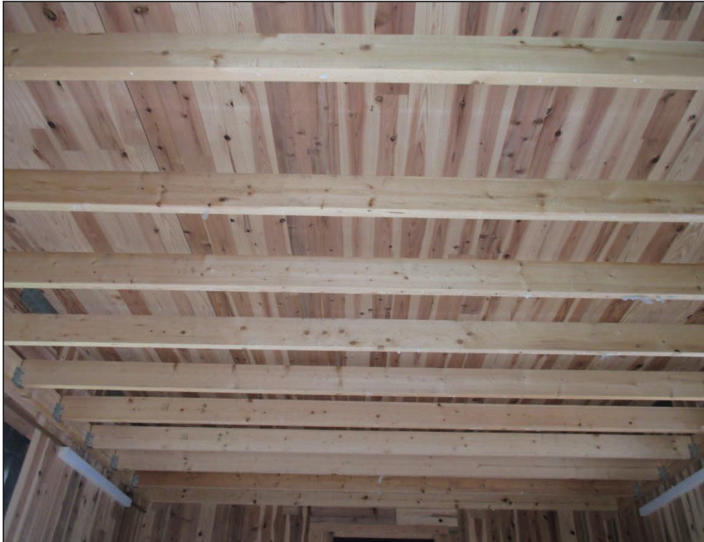
(1) 試験体 A2-1 (背後空気層 t465mm) の天井根太
