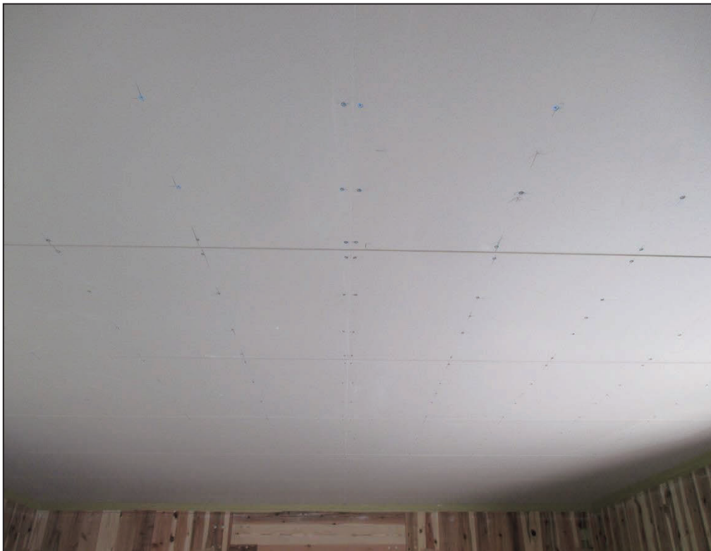
(2) 試験体 A3-2 : 2 層目の強化せっこうボード t25mm を施工し完成した状態
