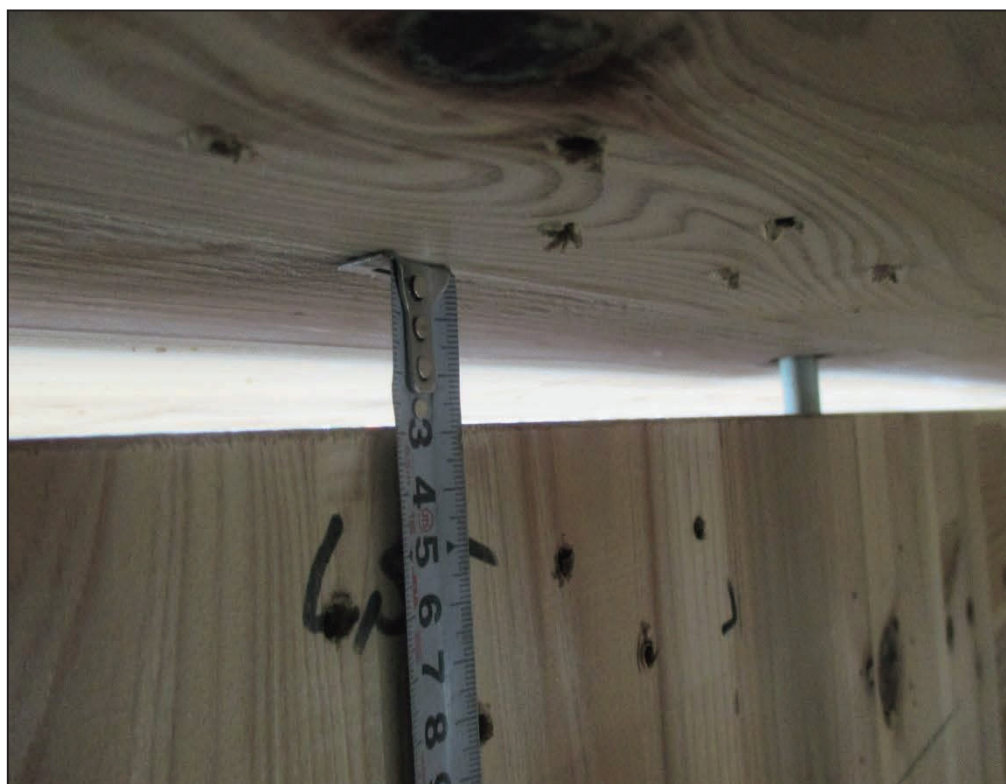
(2) 試験体 B2-1 : 2 階床を 30mm ジャッキアップして 1 階壁上部に隙間を空けた状態 写真 4. 2. 3. 1 試験体 B2-0~B2-4 (壁への振動伝達低減による対策) の外観
