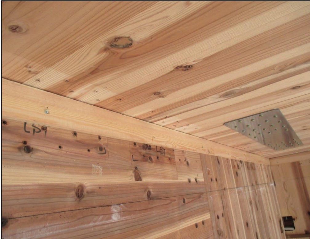
(1) 試験体 B2-2 : 1 階壁上部の隙間を幅木で塞いだ状態
