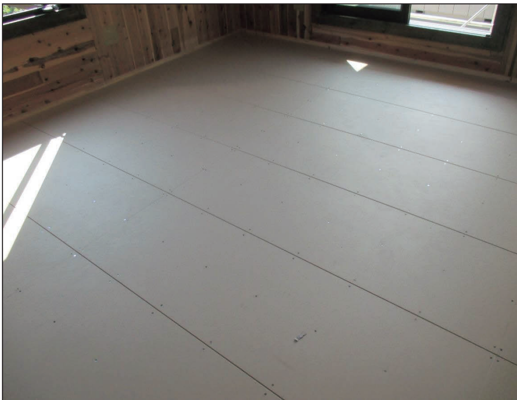
(2) 試験体 A3-1 : 根太 t18mm の上に強化せっこうボード t21mm×2 層を施工
