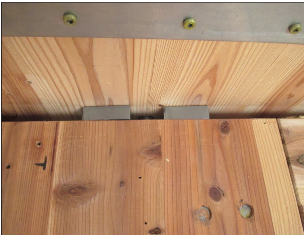
(2) 試験体 B2-3 : 上下ボルトの両側に鉄板を挟み込んだ状態
