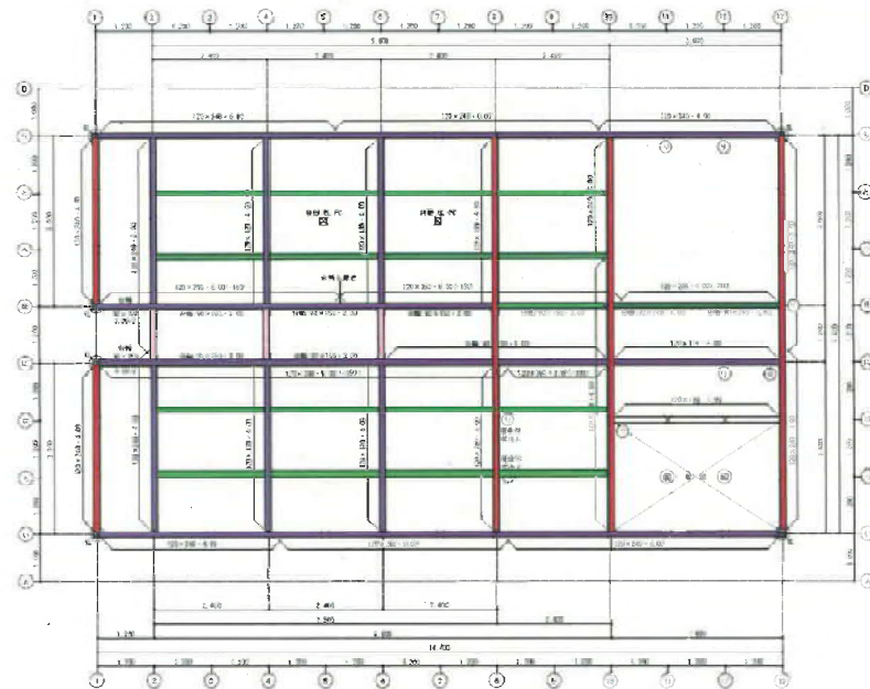
図 軸組工法等の梁伏図の例
