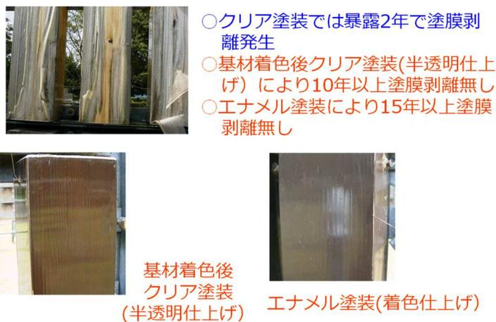
図 17 :フッ素系塗装の基材及び塗膜の着色による耐候性向上効果
