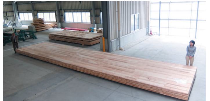
国内で製造可能な最大のCLTパネル(幅3m×長さ12m、銘建工業)
