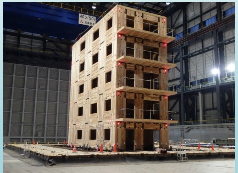
CLTパネル工法5階建ての実大振動台実験
