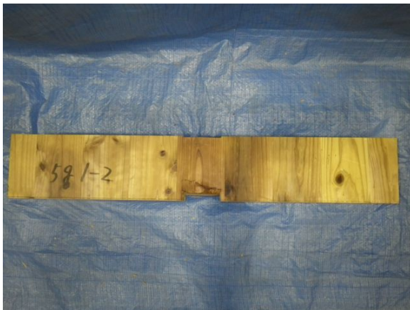
写真 8.6-a), b) 破壊形態 (5層・同一等級・弱軸・縦使い)
