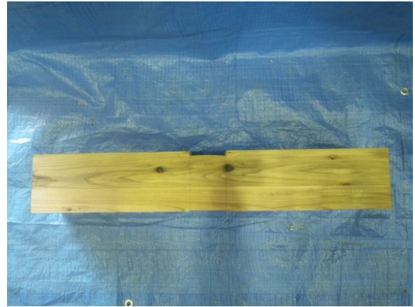
写真 8.8-a), b) 破壊形態 (5層・異等級・強軸・縦使い)
