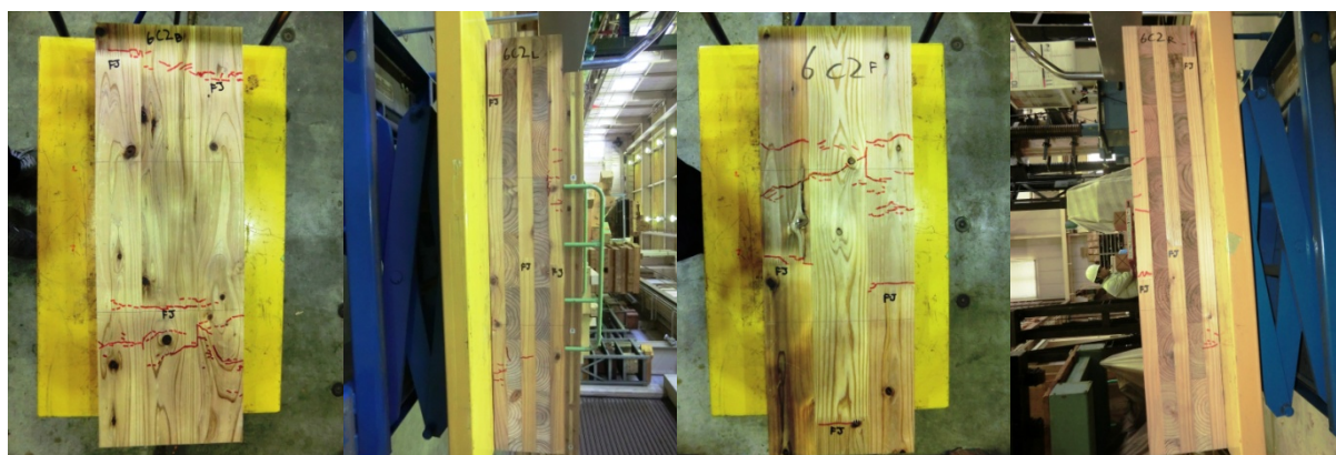
写真7. 7 5層5プライ（同一等級、強軸、6c2）の破壊性状
