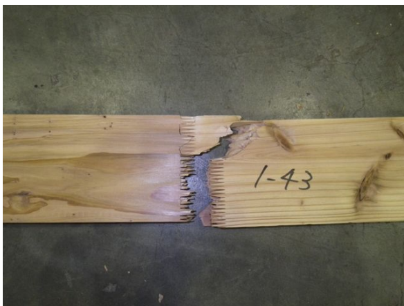
c) フィンガージョイントと節による複合破壊の例 (左 : L60~L70、右 : L30~L50)
