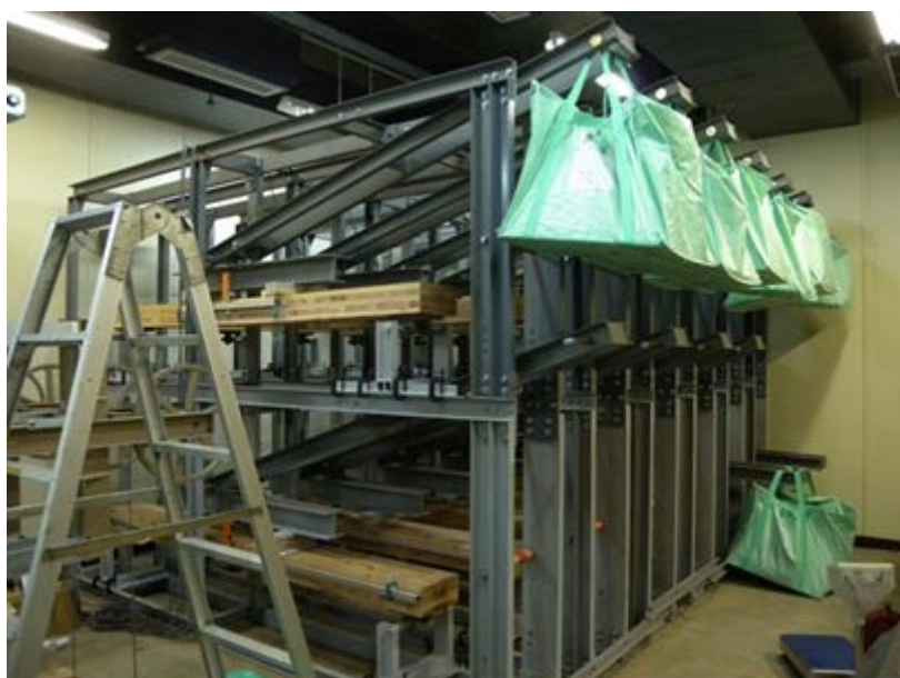
写真 4.2 クリープ試験とクリープ破壊試験の様子
