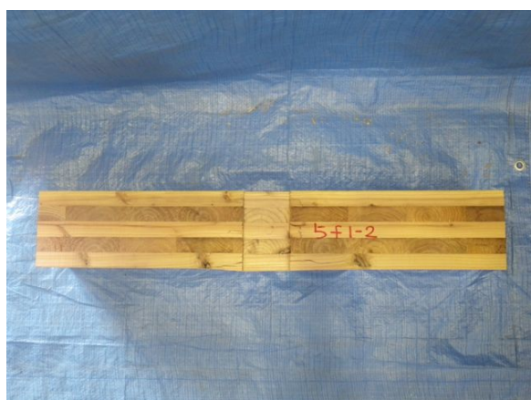
写真 8.4-a), b) 破壊形態 (5層・同一等級・強軸・縦使い)
