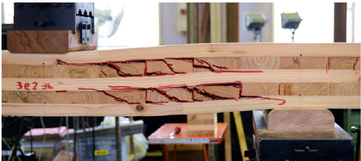
写真6-3 最終破壊性状(3e2)
