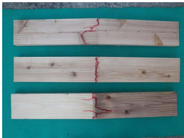
写真 9-1 L30～L40 ラミナ破壊状況例
