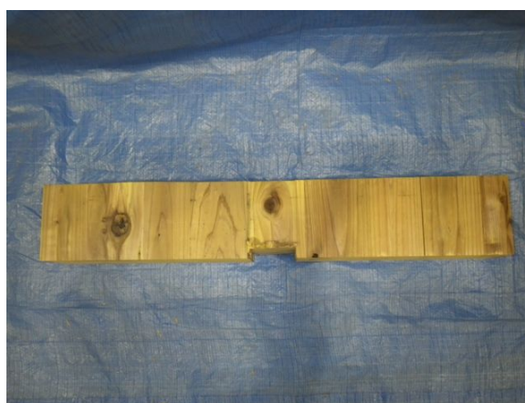
写真 8.10-a), b) 破壊形態 (5層・異等級・弱軸・縦使い)
