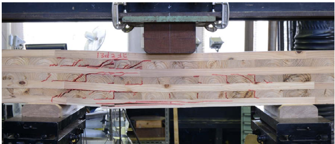
写真6-10 セン断ひび割れ発生時の性状(13e2)
