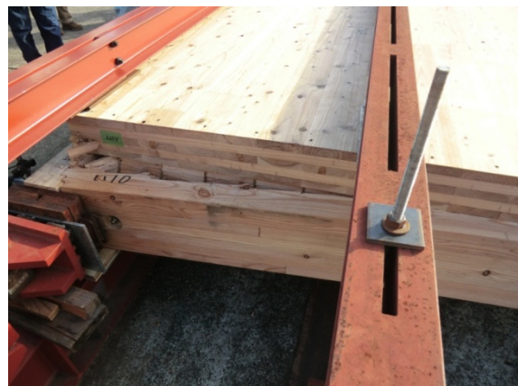
写真 2-10 北側桁材の割裂破壊
