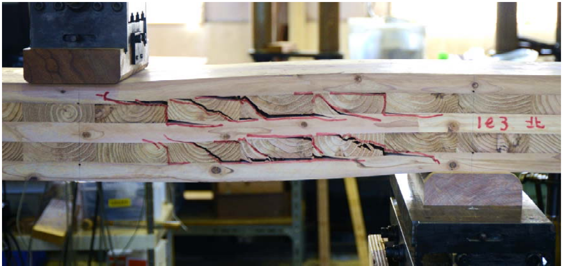
写真6-1 最終破壊性状(1e3)
