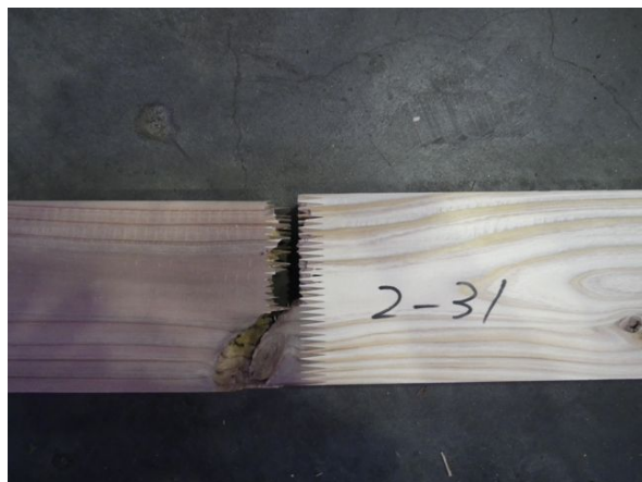
c) フィンガージョイントと節による複合破壊の例 (左 : L60~L70、右 : L30~L50)
