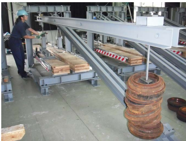
写真 5-9 加力点ネジ回転による載荷
