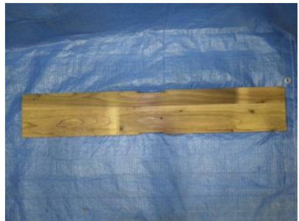
写真 8.12-a), b) 破壊形態 (7層・同一等級・強軸・縦使い)
