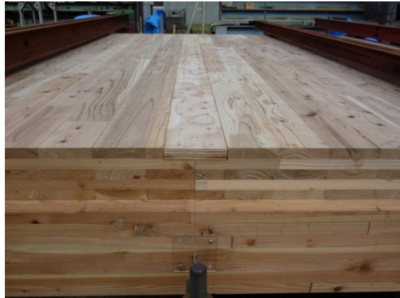
写真 2-6 厚物合板によるスプライン接合
