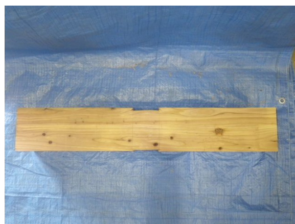
写真 8.4-a), b) 破壊形態 (5層・同一等級・強軸・縦使い)
