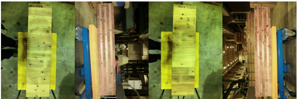
写真7. 15 7層7プライ（同一等級、弱軸、14d1）の破壊性状
