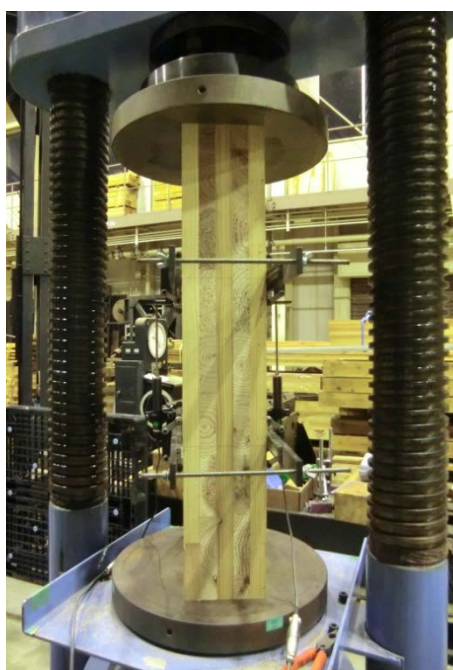
写真 7.1 縦圧縮試験の様
