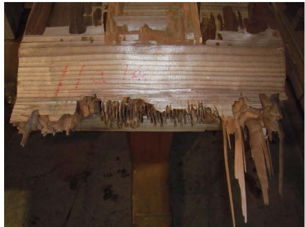
写真 5-18 No11a14 破壊状況
