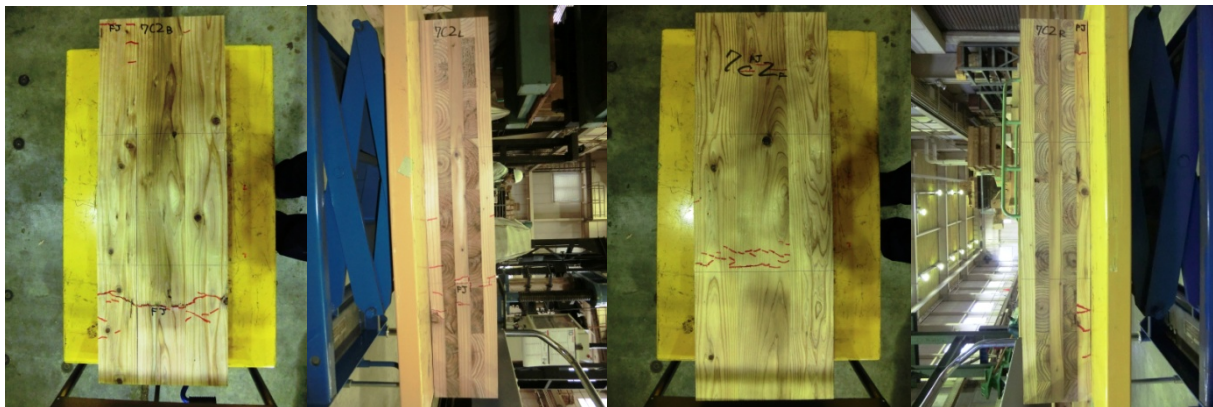
写真7. 10 5層5プライ（異等級、強軸、7c2）の破壊性状
