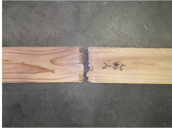
a) フィンガージョイントによる破壊の例 (左 : L60~L70、右 : L30~L50)
