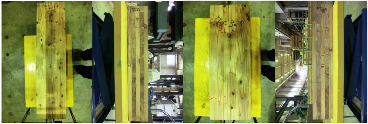
写真7. 1 1 5層5プライ（異等級、強軸、7c3）の破壊性状
