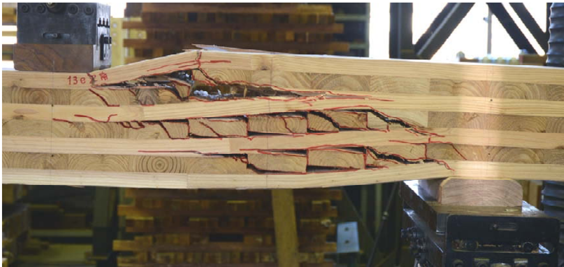
写真6-5 最終破壊性状(13e2)
