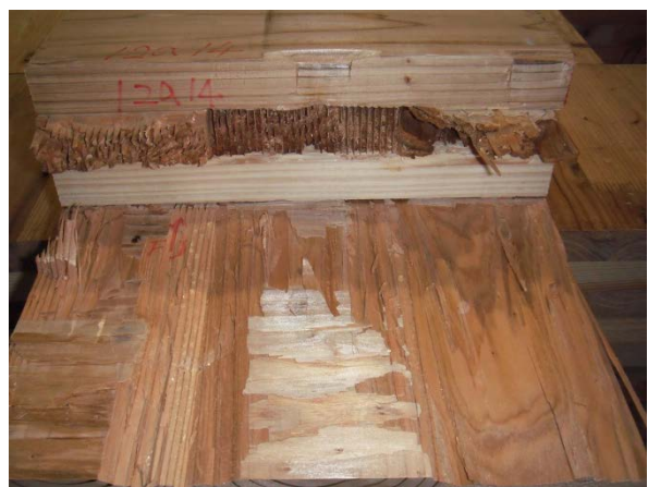
写真 5-20 No12a14 破壊状況
