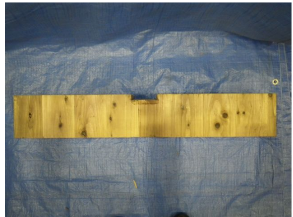
写真 8.14-a), b) 破壊形態 (7層・同一等級・弱軸・縦使い)
