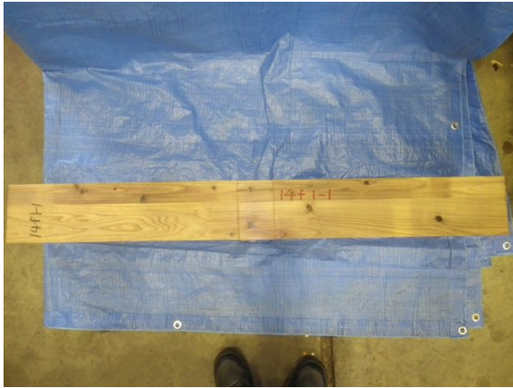
写真 8.11-a), b) 破壊形態 (7層・同一等級・強軸・平使い)
