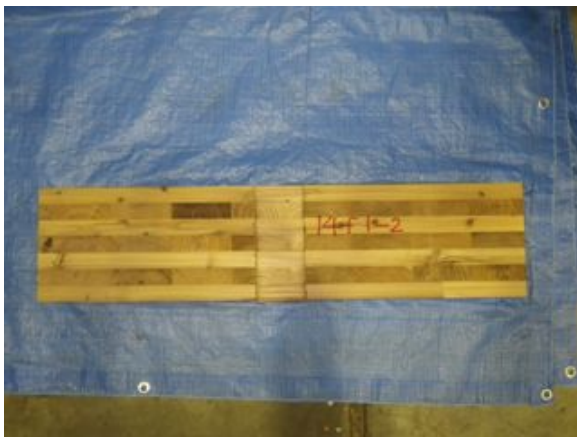
写真 8.12-a), b) 破壊形態 (7層・同一等級・強軸・縦使い)
