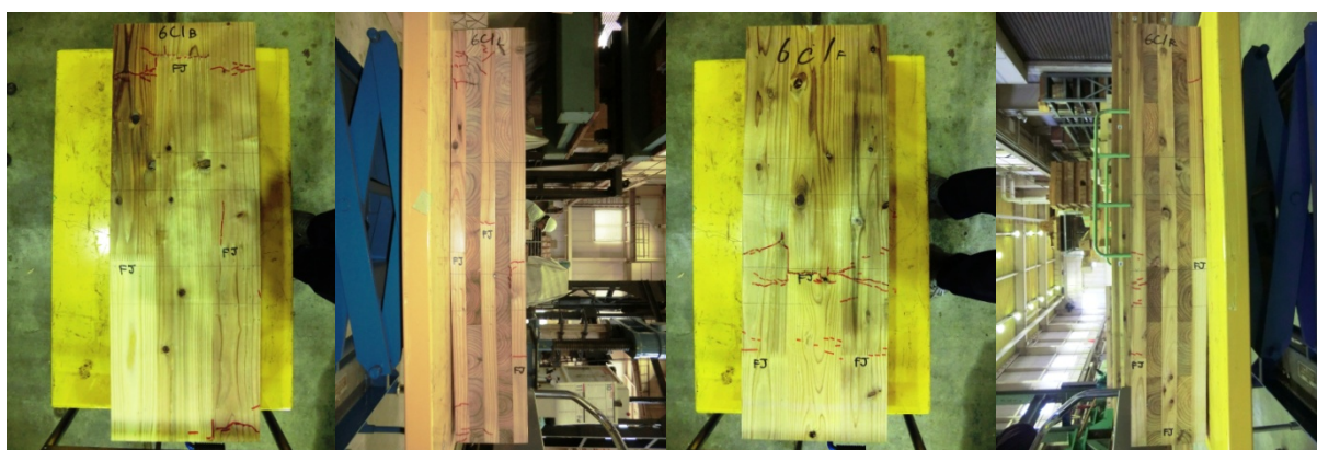
写真7. 6 5層5プライ（同一等級、強軸、6c1）の破壊性状
