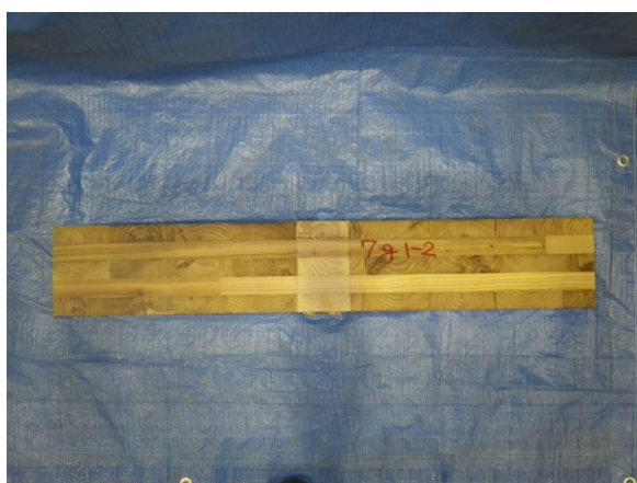
写真 8.10-a), b) 破壊形態 (5層・異等級・弱軸・縦使い)
