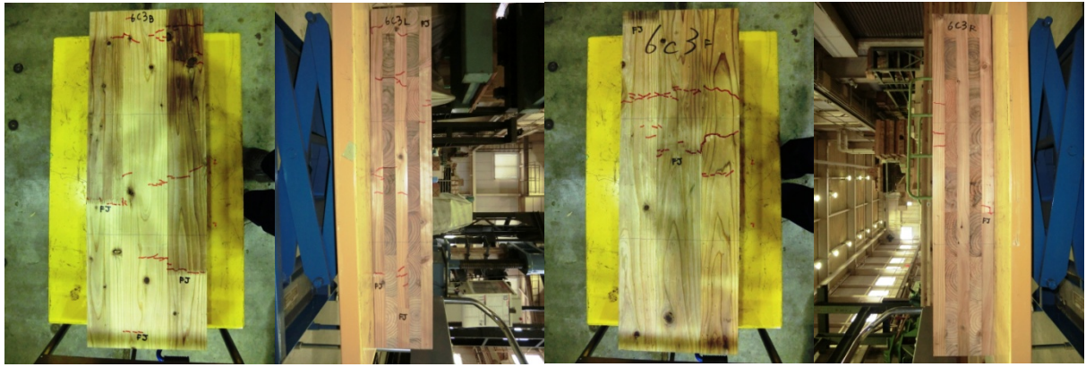
写真7. 8 5層5プライ（同一等級、強軸、6c3）の破壊性状
