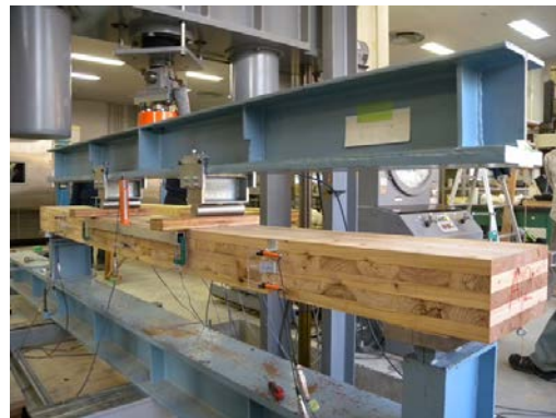
写真 4.1 曲げ試験の様子（幅はぎありの試験体）
