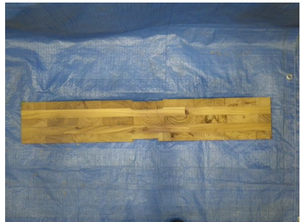
写真 8.9-a), b) 破壊形態 (5層・異等級・弱軸・平使い)
