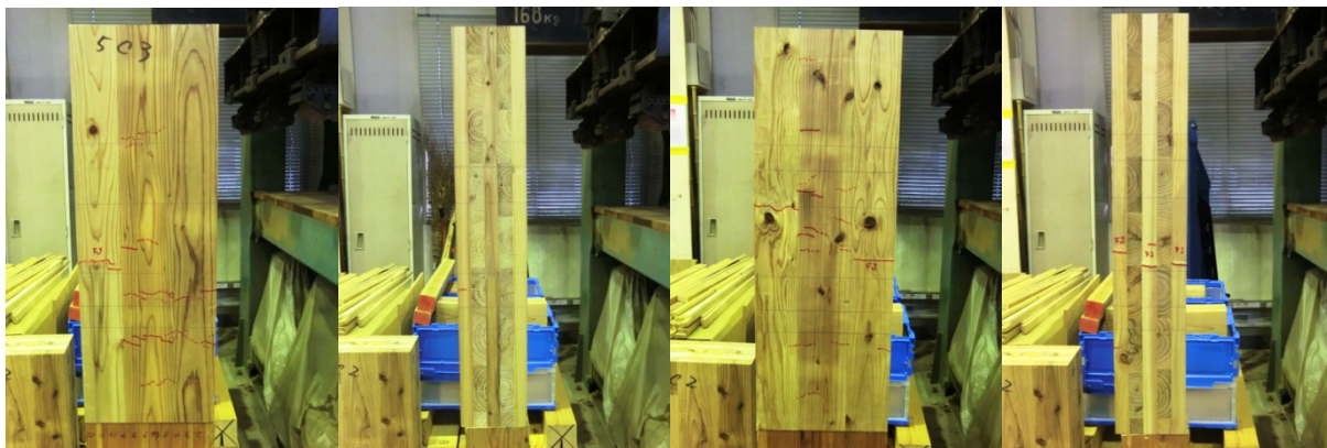
写真7. 5 5層5プライ（同一等級、強軸、5c3）の破壊性状
