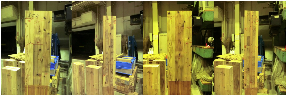
写真 7. 4 5層5プライ（同一等級、強軸、5c2）の破壊性状
