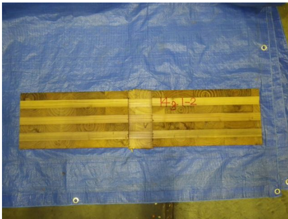
写真 8.14-a), b) 破壊形態 (7層・同一等級・弱軸・縦使い)
