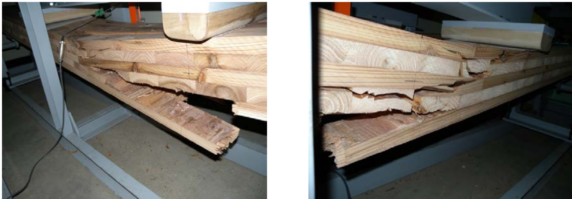
写真 4.3 クリープ破壊試験における試験体の破壊形状 (荷重比 : 80%)
