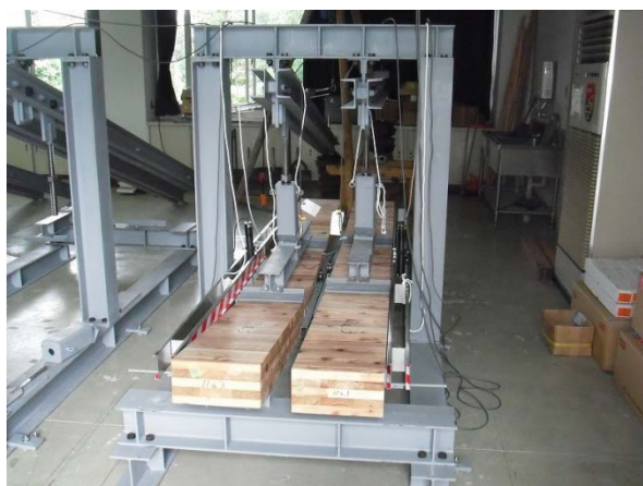
写真 5-13 長期载荷試験状況 1
