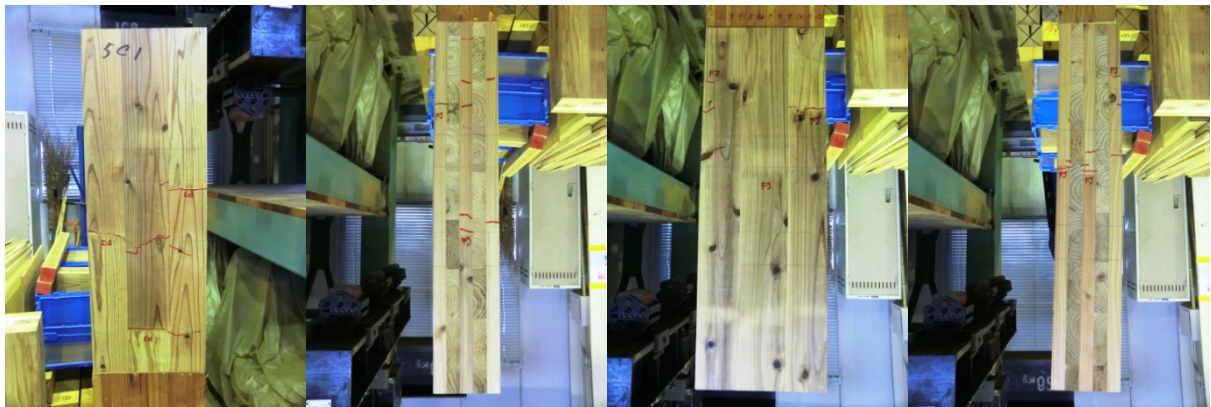
写真 7. 3 5層5プライ（同一等級、強軸、5c1）の破壊性状
