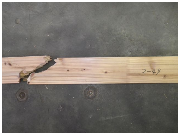
b) 節による破壊の例 (左 : L60~L70、右 : L30~L50)
