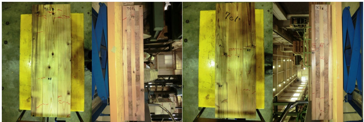
写真7. 9 5層5プライ（異等級、強軸、7c1）の破壊性状
