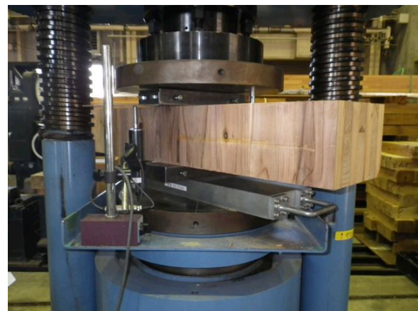
写真 8.2 7層の試験体のめり込み試験
