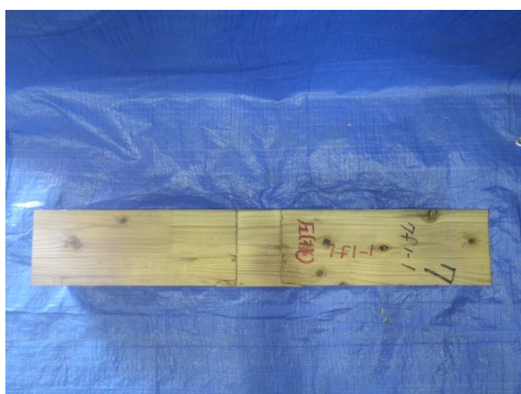
写真 8.7-a), b) 破壊形態 (5層・異等級・強軸・平使い)
