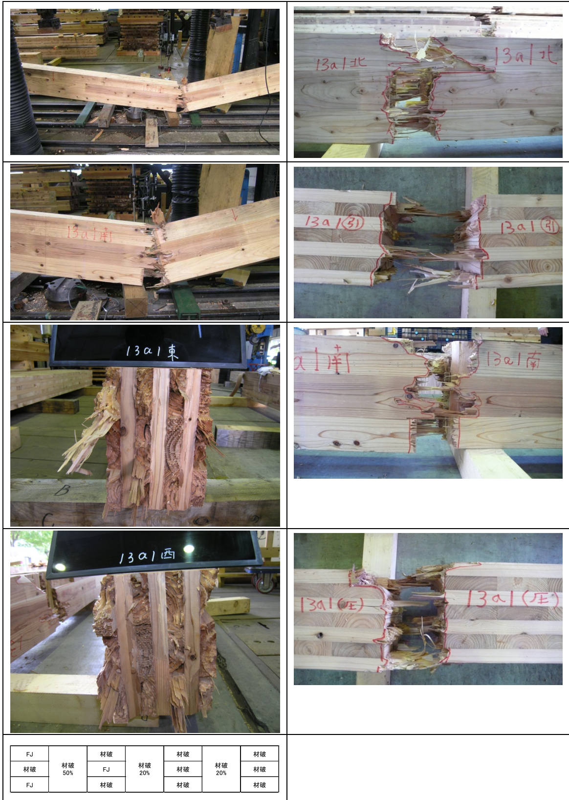
図 3.4.5 7層7プライ同一等級構成 CLT（強軸方向）の破壊の様子（試験体番号 13a1）
