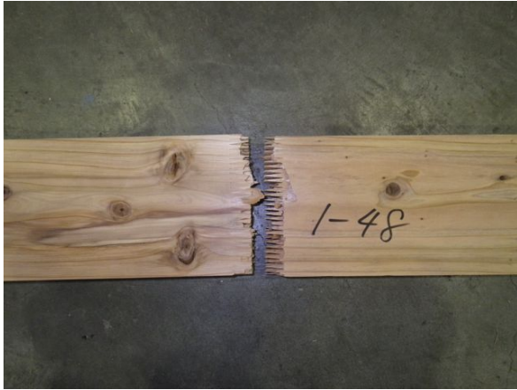
a) フィンガージョイントによる破壊の例 (左 : L60~L70、右 : L30~L50)
