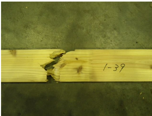
b) 節による破壊の例 (左 : L60~L70、右 : L30~L50)
