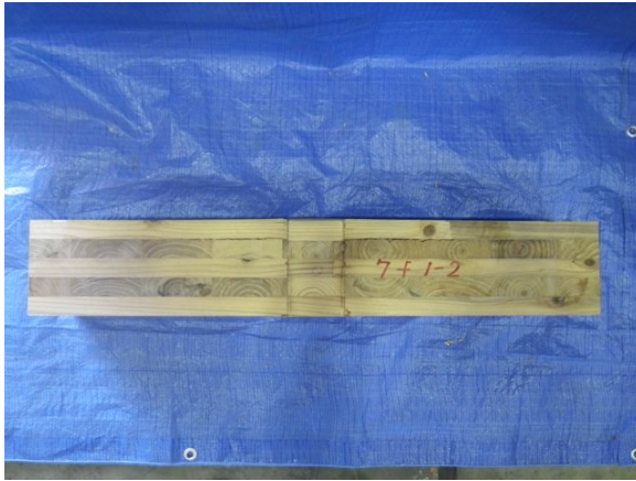
写真 8.8-a), b) 破壊形態 (5層・異等級・強軸・縦使い)
