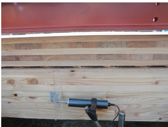
写真 2-9 梁材留付用ビスの引き抜け
