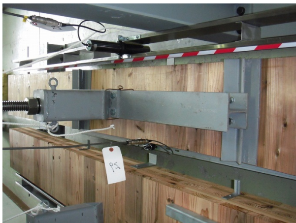
写真 5-10 荷重点と変位計の取付け
