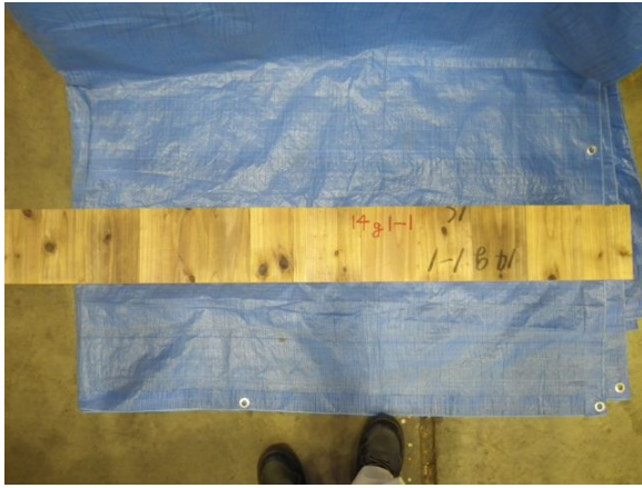
写真 8.13-a), b) 破壊形態 (7層・同一等級・弱軸・平使い)
