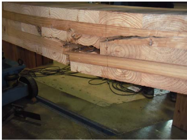
写真 5-12 FJ からの破壊例 2
