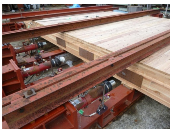
写真 2-8 加力ジャッキと加圧板
