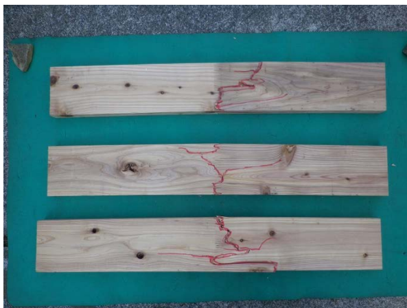
写真 9-2 L60～L70 ラミナ破壊状況例
