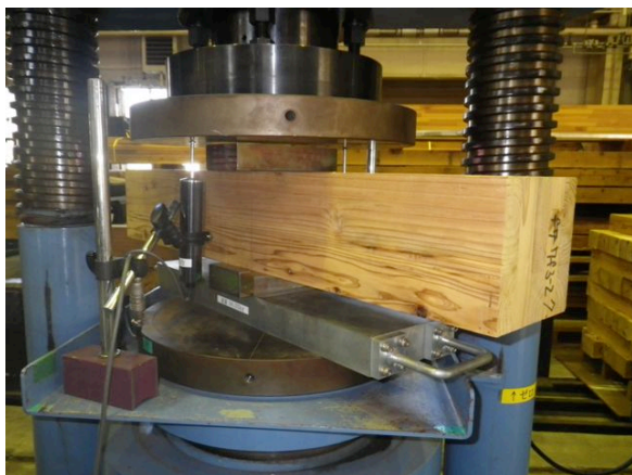
写真 8.1 5層の試験体のめり込み試験
