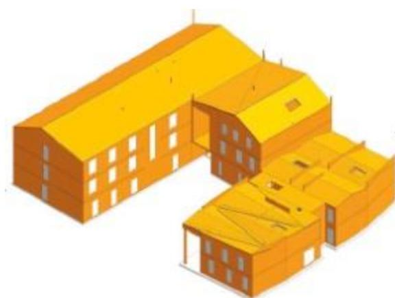
図 3-3 建物のアイソメ図(右側2階建ての屋根が折板構造)<sup>\*3</sup>
