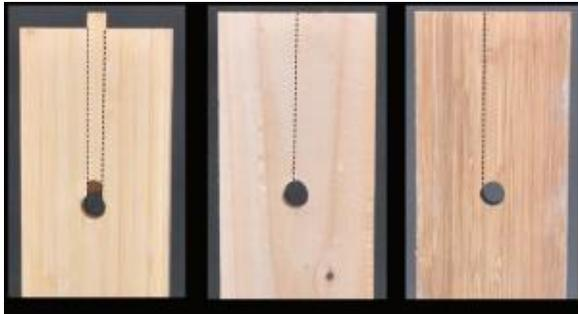
図 8-1 一般木材と竹繊維を接着した板材のボルト穴せん断強度試験<sup>\*8</sup>
