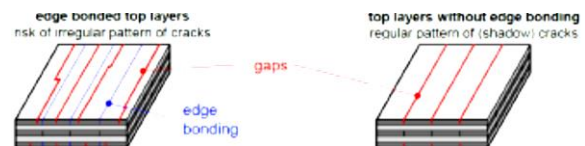
図 5-1 幅はぎ接着の利点と欠点*2 (左は幅はぎ接着あり、右は幅はぎ接着なし)
