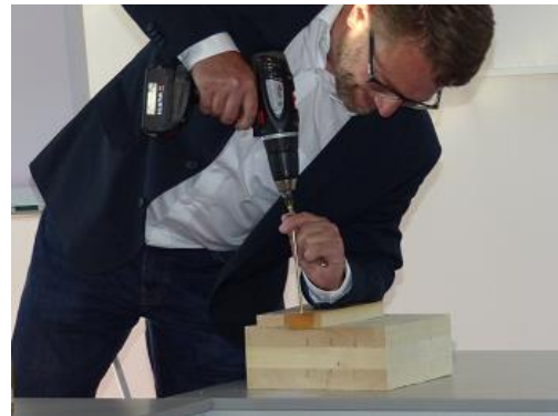
写真 16-1 薄板の端部にビスを打ち込む様子(先端形状による木材割裂の比較)
