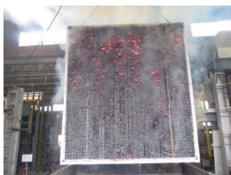
写真 2.2-12 試験後の加熱側の状況
