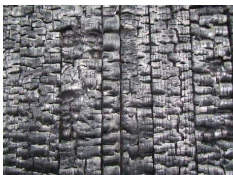
写真 2.2-44 試験後の加熱側の状況(目地 C1)
