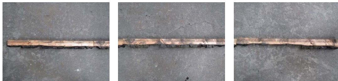
写真 2.2-5 試験後の断面状況（断面Ⅰ）
