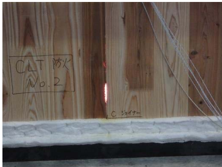
写真 2.2-9 目地 C の試験中の状況（炉内への貫通の状況）
