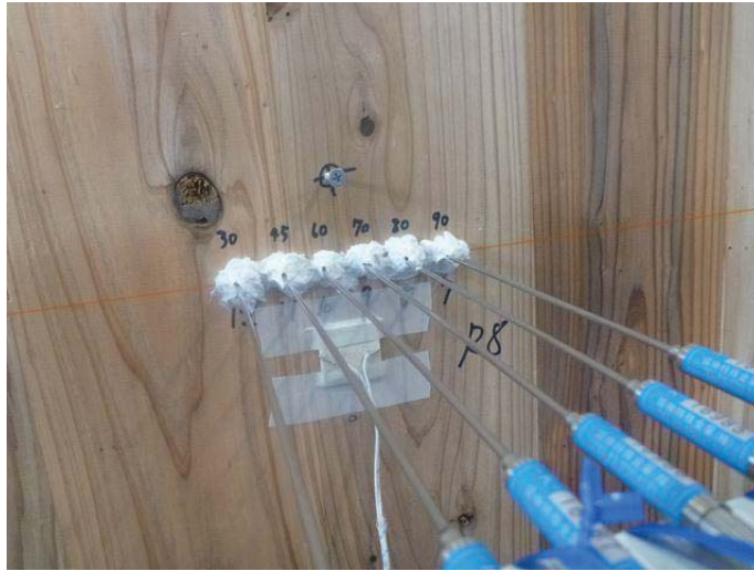
写真 2.1-1 CLT 一般部 シース熱電対取付状況：試験体 No.1
