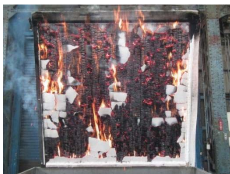
写真 2.2-3 試験後の加熱側の状況
