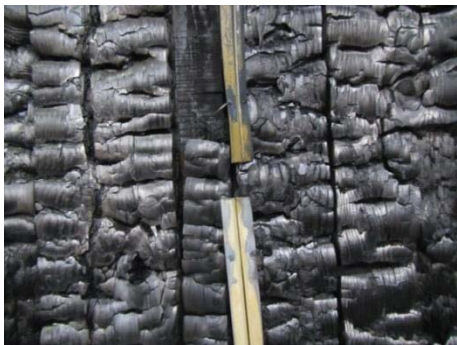
写真 2.2-24 試験後の加熱側の状況（目地 C）
