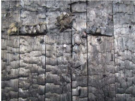
写真 2.2-62 加熱側の状況 (仕様 A ,断熱材除去後)
