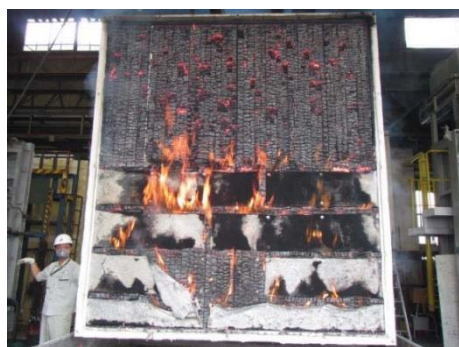
写真 2.2-31 試験後の加熱側の状況
