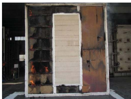
写真 2.2-54 試験後の加熱側の状況
