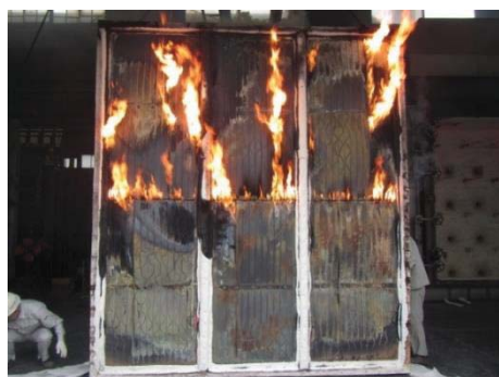
写真 2.2-80 試験後の加熱側の状況
