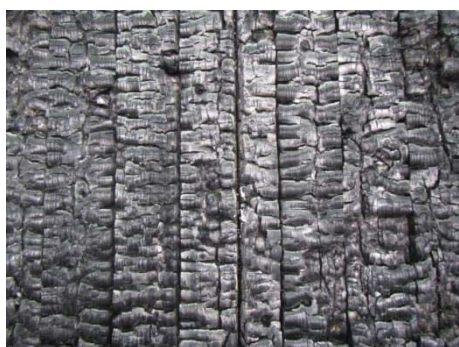
写真 2.2-40 試験後の加熱側の状況(目地 A1)
