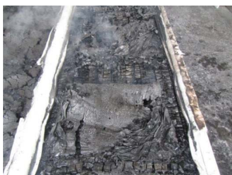
写真 2.2-92 加熱側の状況 (仕様 C, 外装材除去後)
