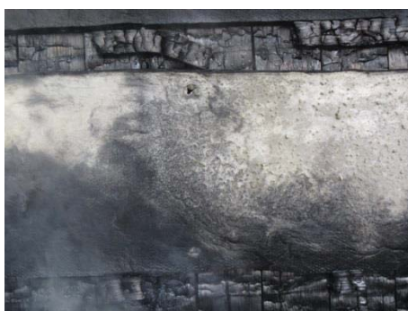
写真 2.2-47 試験後の加熱側の状況 グラスウールの留付材 ・スクリュー傘くぎ、 \#13 \times 41
