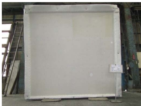
写真 2.2-1 試験前の加熱側の状況
