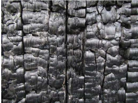
写真 2.2-20 試験後の加熱側の状況（目地 A）
