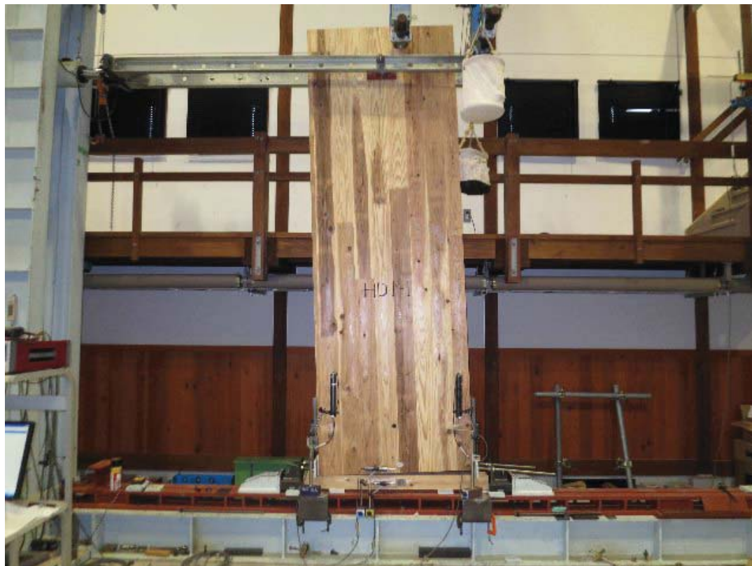
写真 3.2.2.4-2 最大変形時の試験体全景 (HD1-1)
