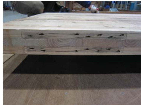
写真 3.3-2 HD 耐力壁の壊れ方 (縁距離 長)
