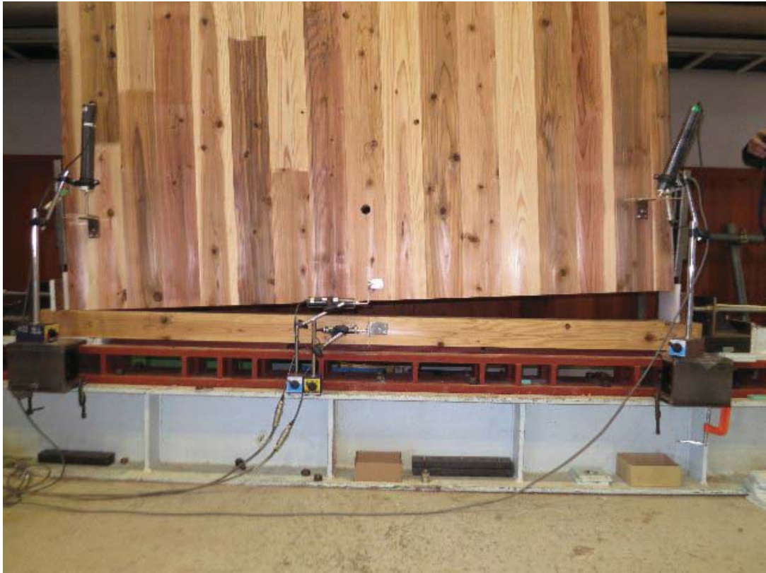
写真 3.2.2.4-15 柱脚部浮き上がりの様子 (HD2-1)
