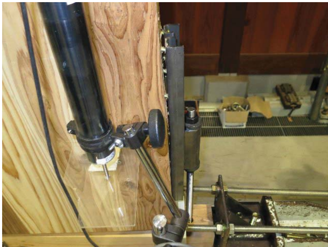
写真 3.2.2.4-4 引き寄せ金物のはずれ (HD1-1)
