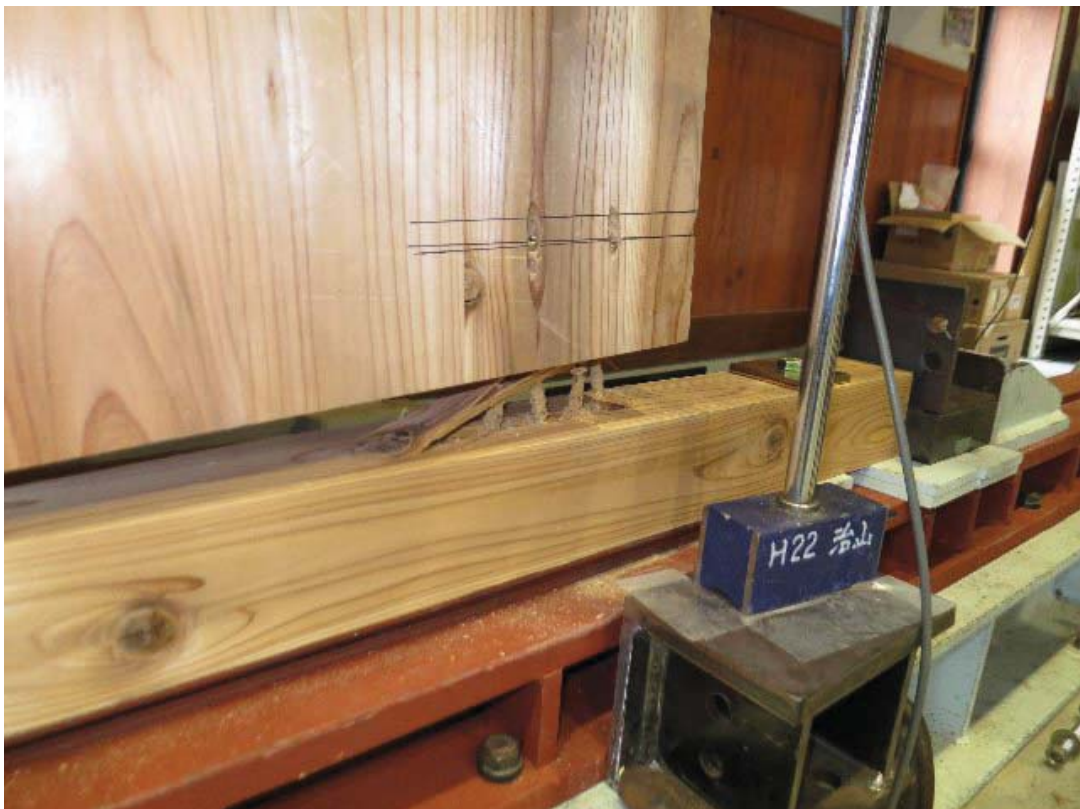
写真 3.2.2.4-44 右柱脚部浮き上がりの様子 (NB1-2)
