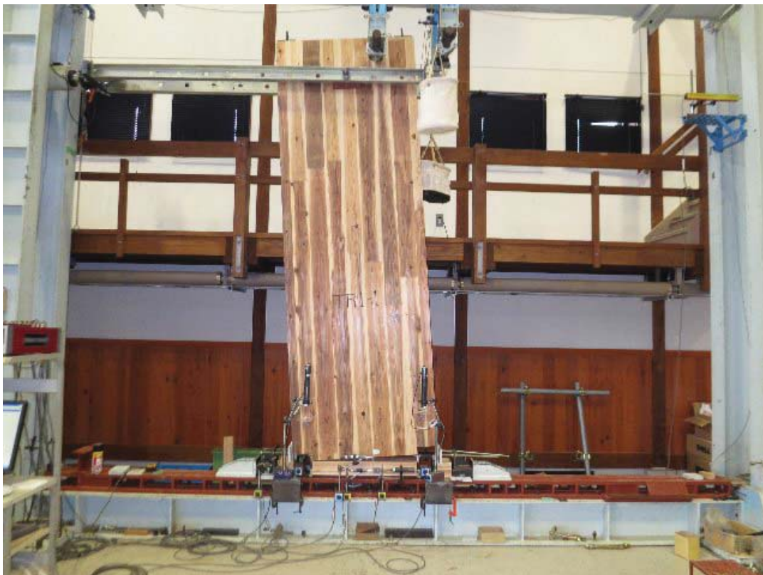
写真 3.2.2.4-34 最大変形時の試験体全景 (TR1-1)
