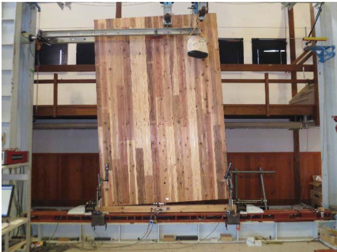
写真 3.2.2.4-14 最大変形時の試験体全景 (HD2-1)
