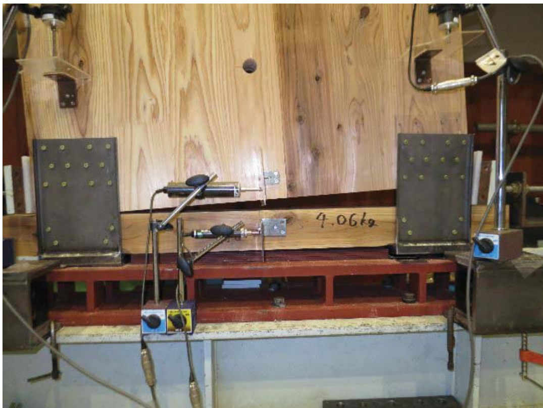
写真 3.2.2.4-19 柱脚部浮き上がりの様子 (L1-1)
