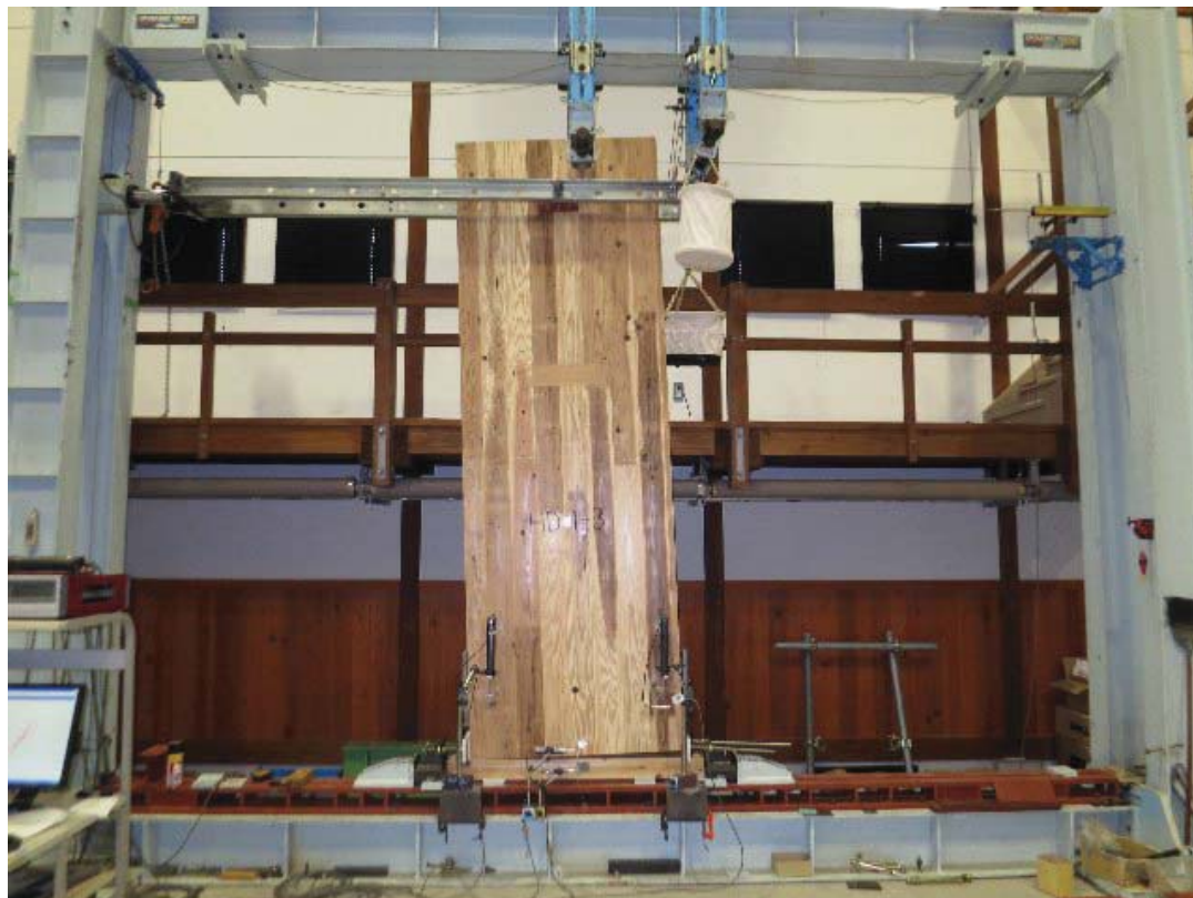
写真 3.2.2.4-10 最大変形時の試験体全景 (HD1-3)
