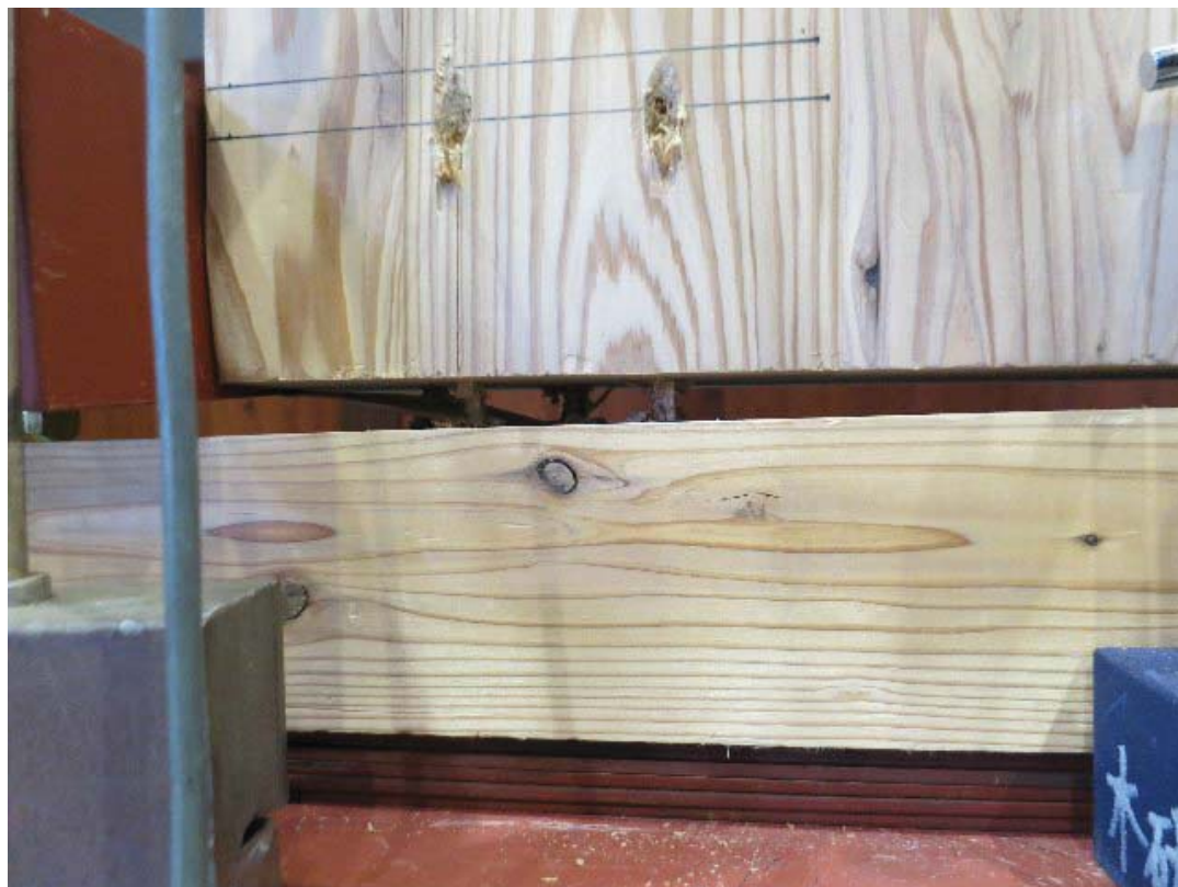
写真 3.2.2.4-40 左柱脚部浮き上がりの様子 (NB1-1)
