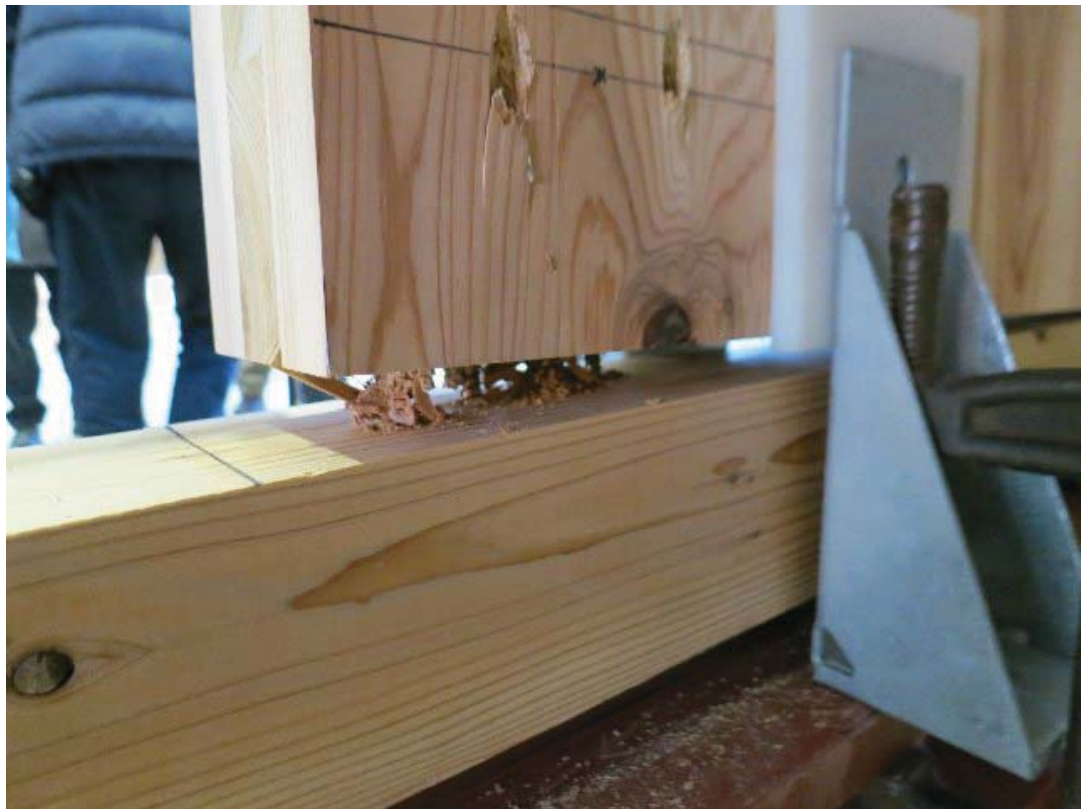
写真 3.2.2.4-48 右柱脚部浮き上がりの様子 (NB1-3)
