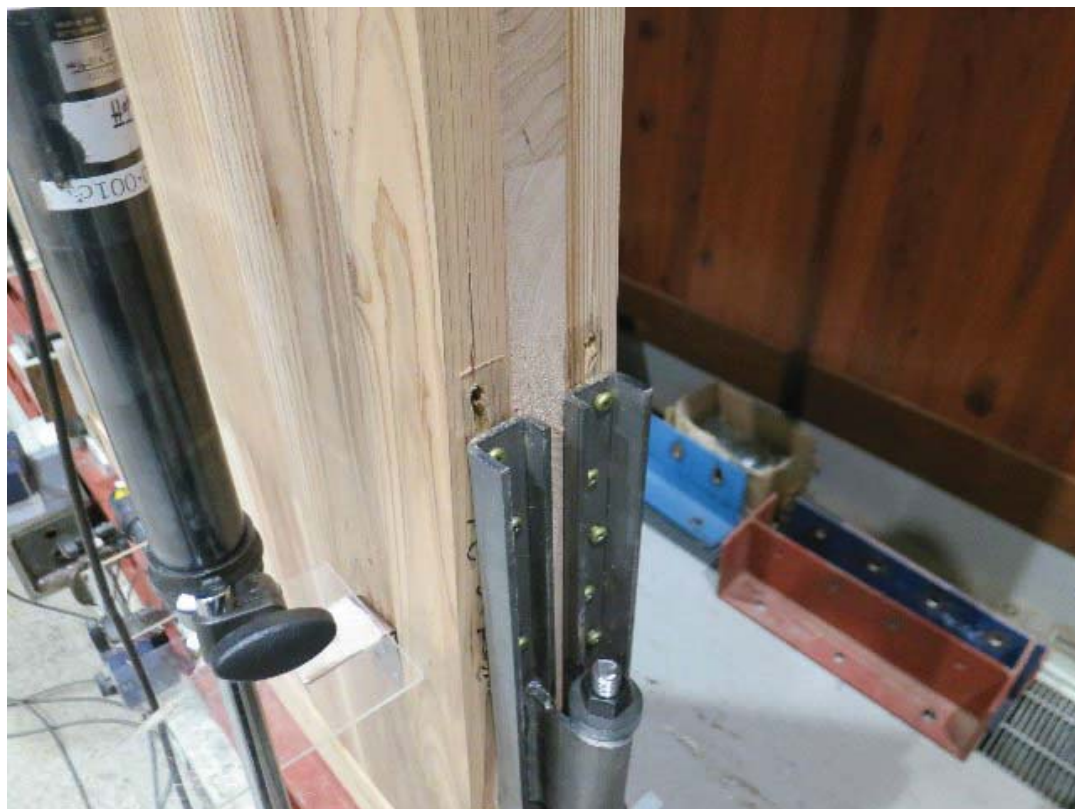
写真 3.2.2.4-8 引き寄せ金物のはずれ (HD1-2)
