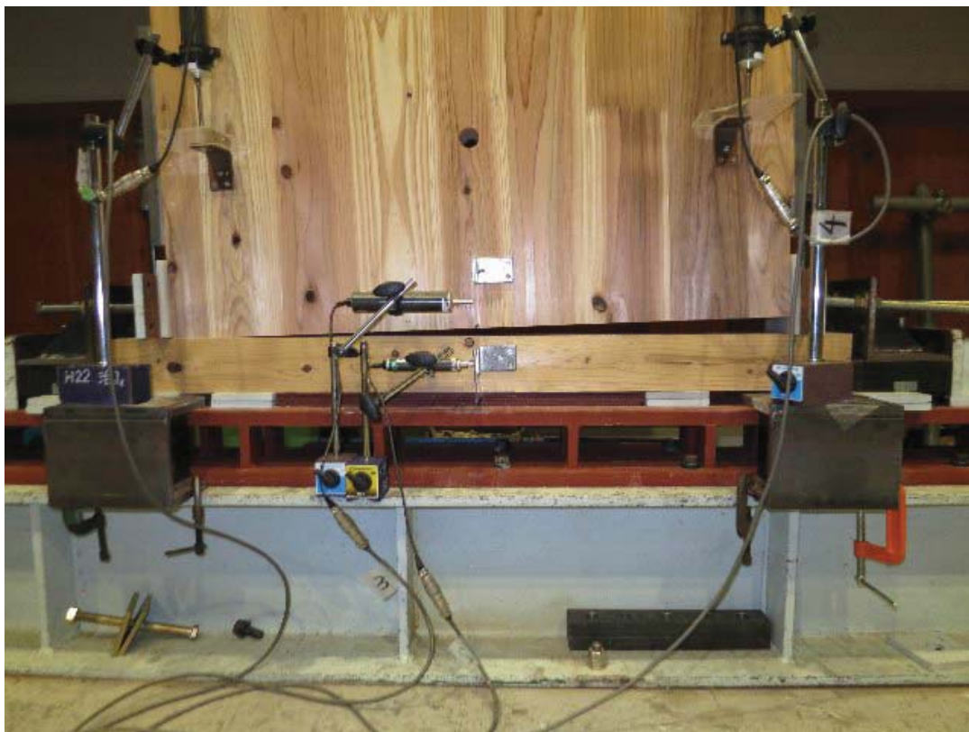
写真 3.2.2.4-7 柱脚部浮き上がりの様子 (HD1-2)
