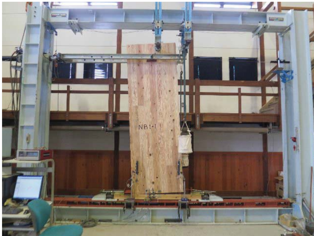
写真 3.2.2.4-38 最大変形時の試験体全景 (NB1-1)
