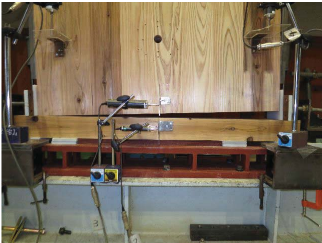
写真 3.2.2.4-11 柱脚部浮き上がりの様子 (HD1-3)
