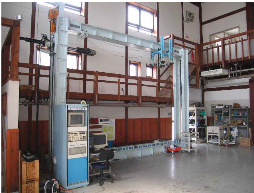
写真 3.2.2.2-1 壁せん断試験機
