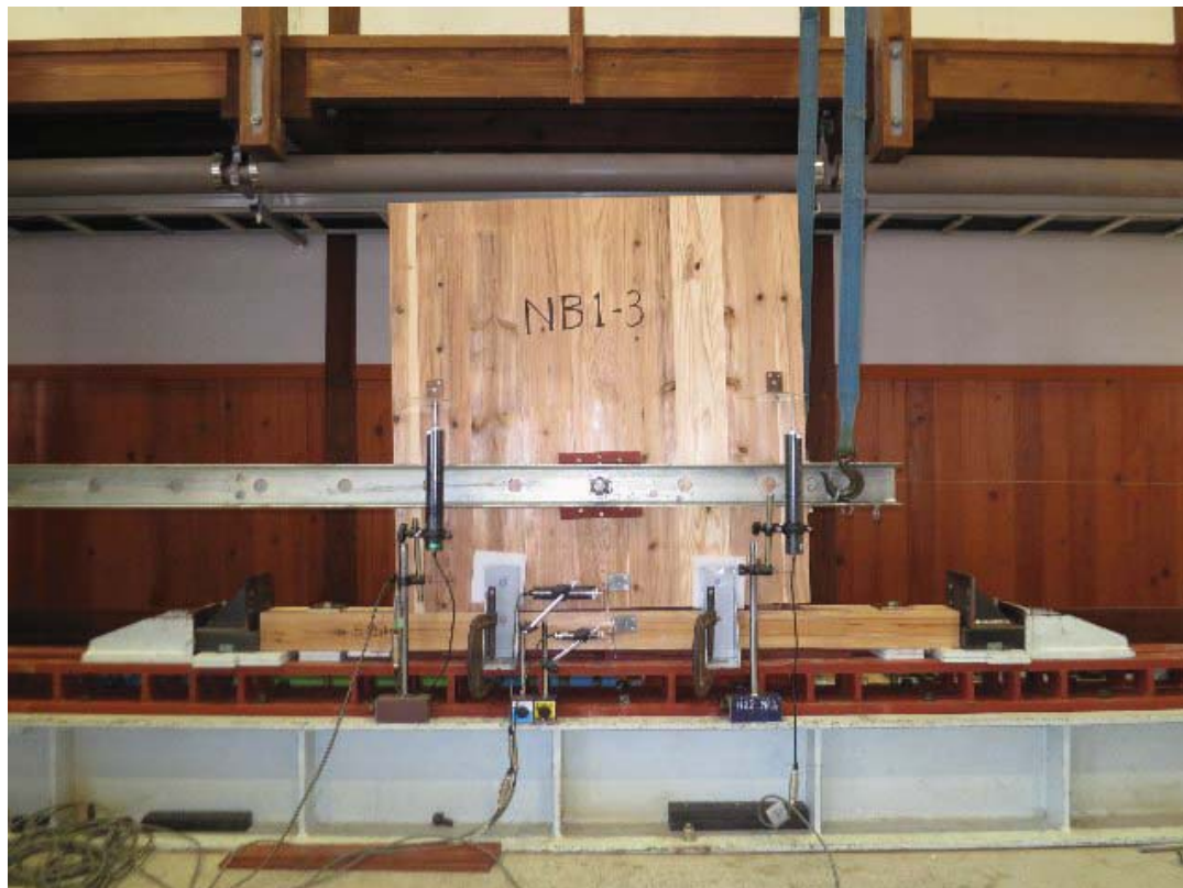
写真 3.2.2.4-46 最大変形時の試験体全景 (NB1-3)
