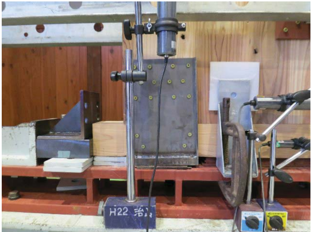
写真 3.2.2.4-28 L型金物のはずれ (L1-3)
