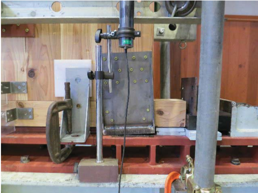
写真 3.2.2.4-27 柱脚部浮き上がりの様子 (L1-3)
