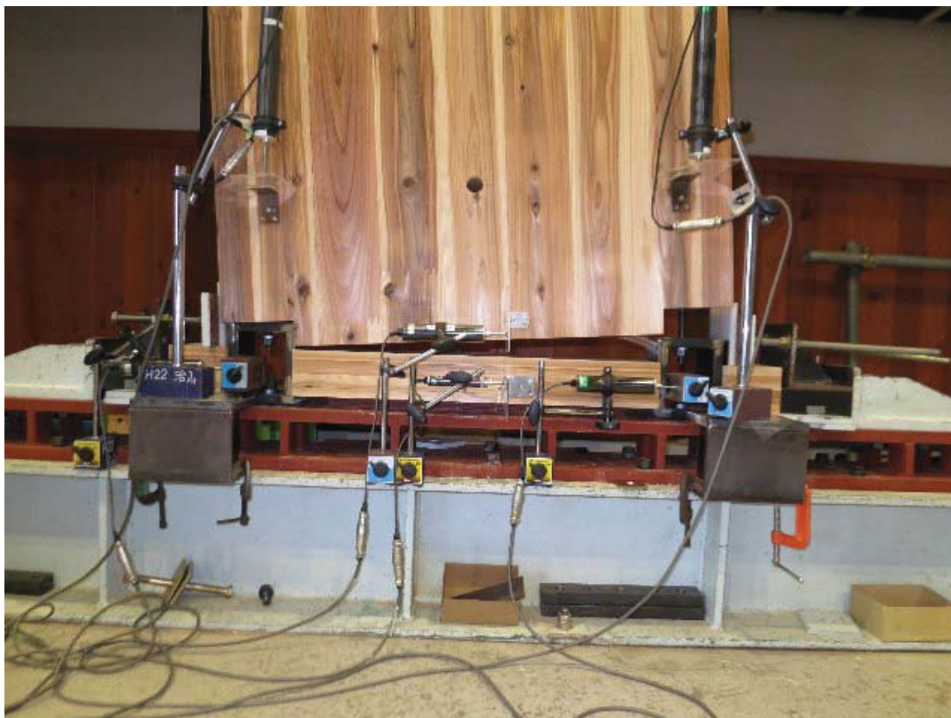
写真 3.2.2.4-35 柱脚部浮き上がりの様子 (TR1-1)
