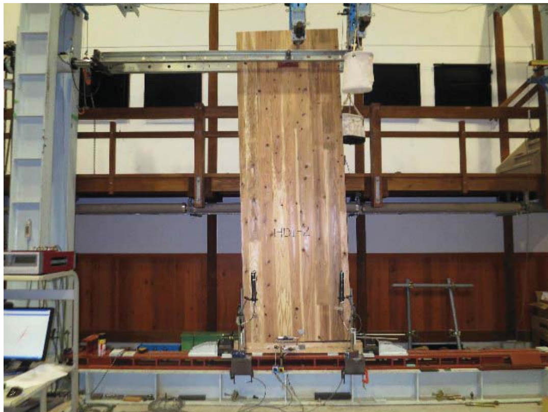
写真 3.2.2.4-6 最大変形時の試験体全景 (HD1-2)
