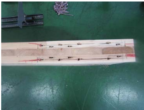
写真 3.3-1 HD 接合部試験の壊れ方 (縁距離 短)
