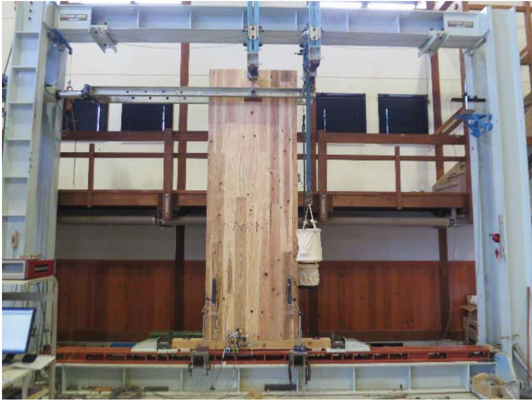
写真 3.2.2.4-41 試験前の試験体全景 (NB1-2)
