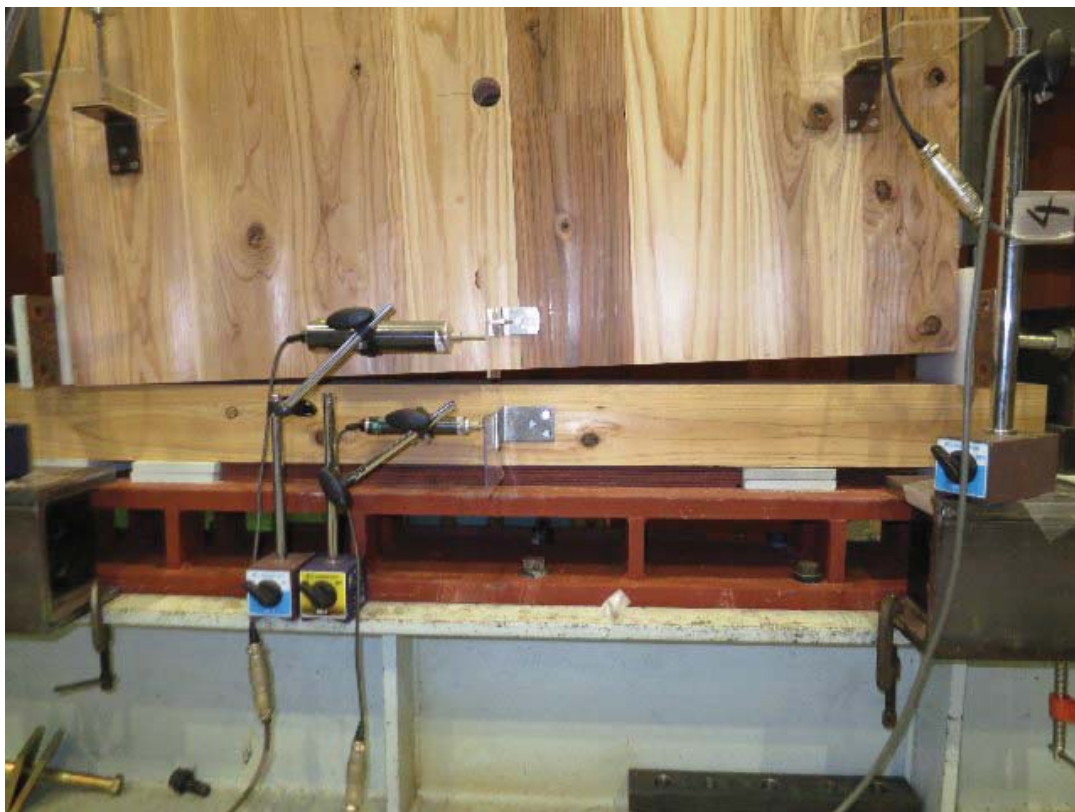
写真 3.2.2.4-3 柱脚部浮き上がりの様子 (HD1-1)
