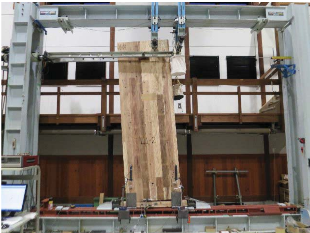
写真 3.2.2.4-22 最大変形時の試験体全景 (L1-2)
