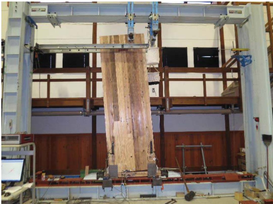
写真 3.2.2.4-18 最大変形時の試験体全景 (L1-1)
