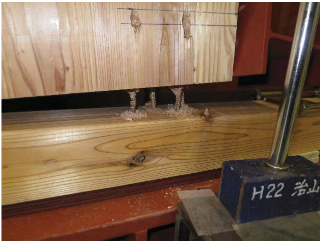
写真 3.2.2.4-39 右柱脚部浮き上がりの様子 (NB1-1)
