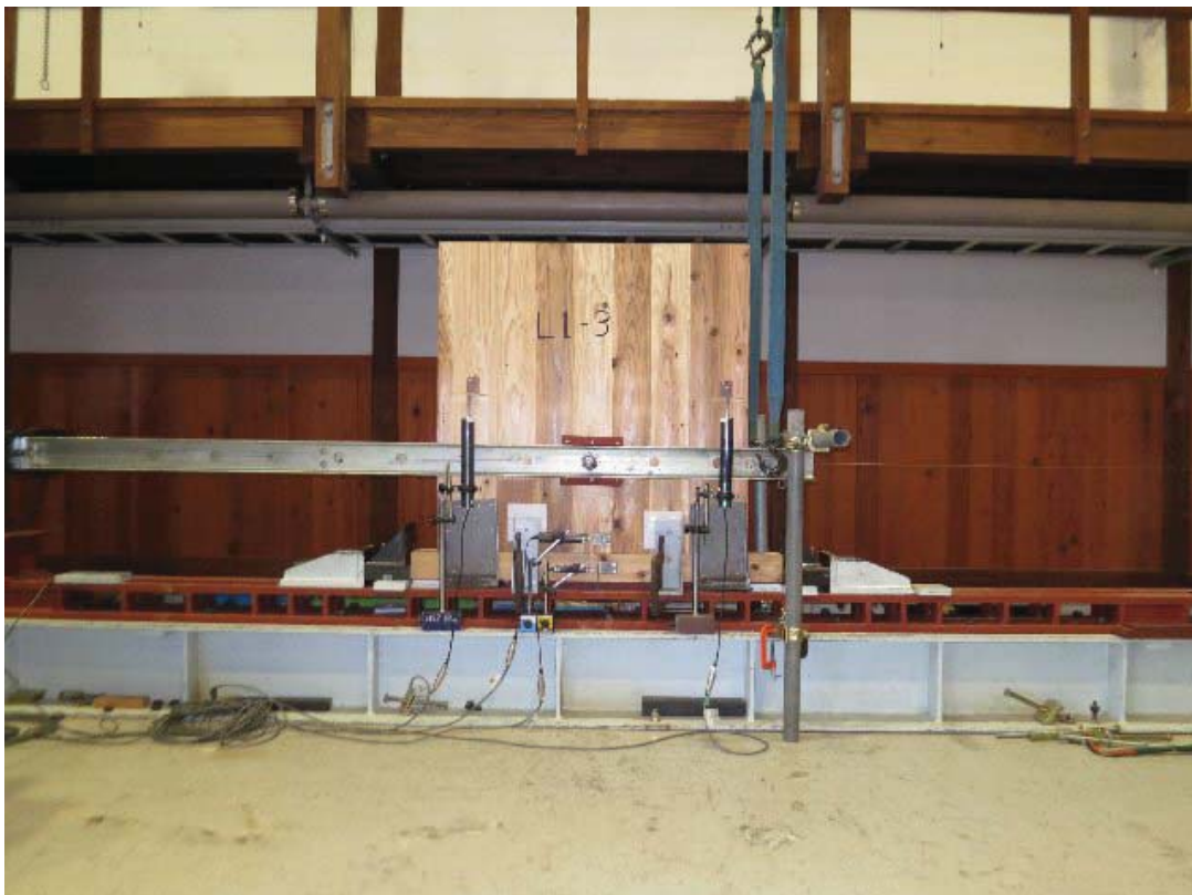
写真 3.2.2.4-26 最大変形時の試験体全景 (L1-3)
