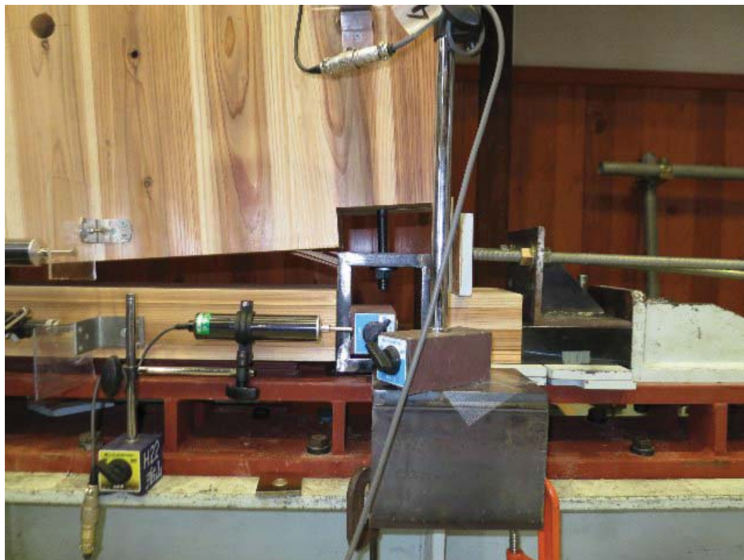
写真 3.2.2.4-36 タイロッドの伸びの様子 (TR1-1)
