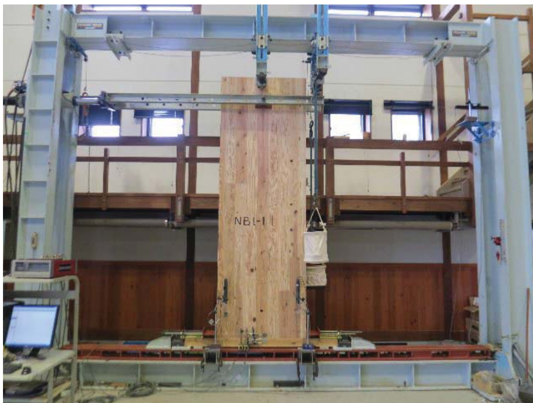
写真 3.2.2.4-37 試験前の試験体全景 (NB1-1)
