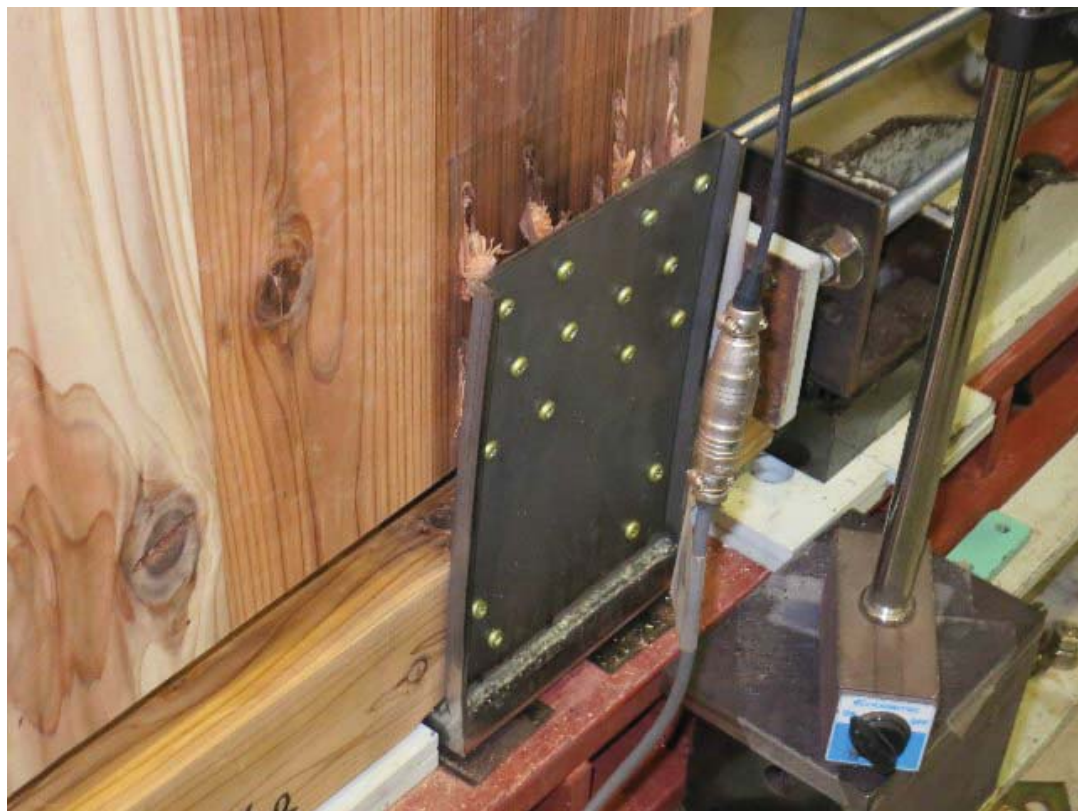
写真 3.2.2.4-32 L型金物のはずれ (L2-1)
