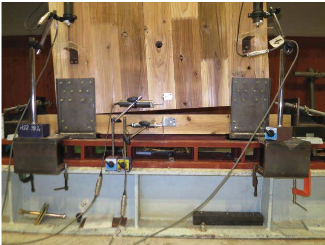
写真 3.2.2.4-23 柱脚部浮き上がりの様子 (L1-2)
