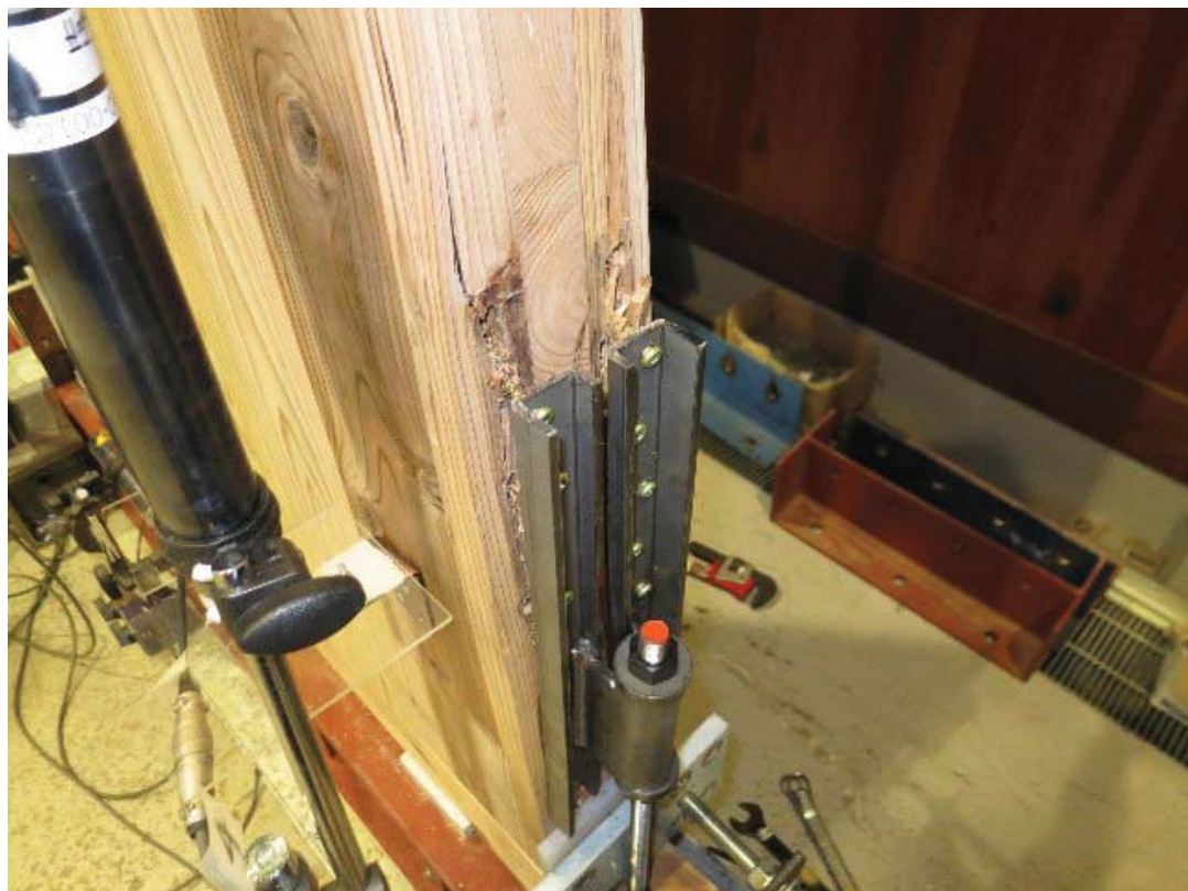
写真 3.2.2.4-12 引き寄せ金物のはずれ (HD1-3)
