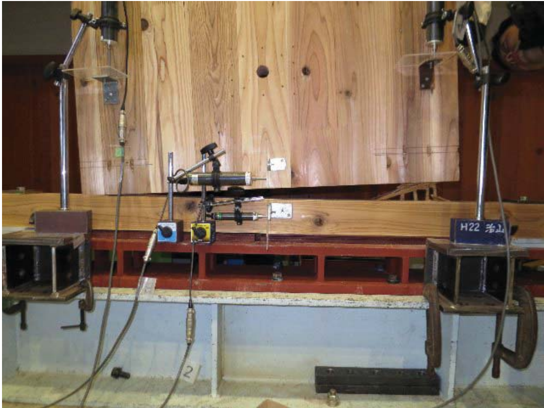
写真 3.2.2.4-43 柱脚部浮き上がりの様子 (NB1-2)
