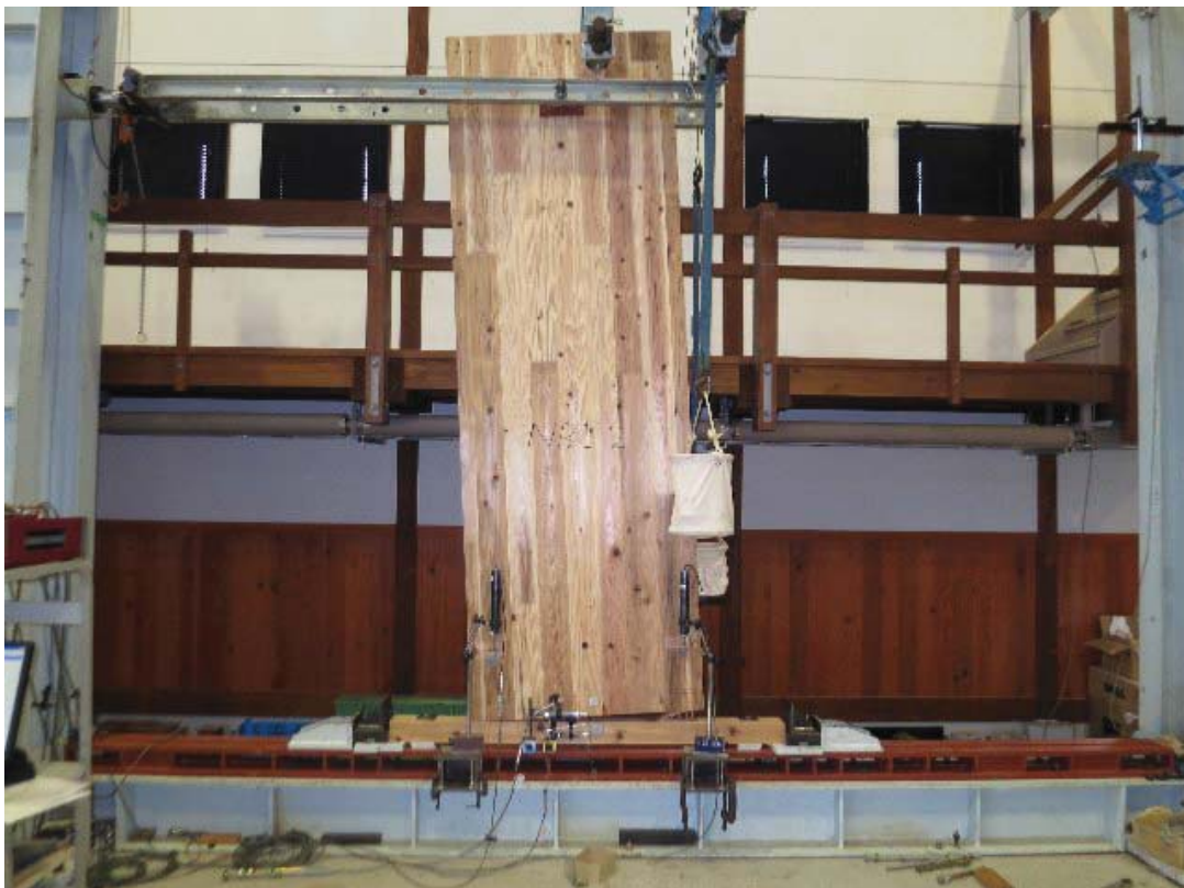
写真 3.2.2.4-42 最大変形時の試験体全景 (NB1-2)
