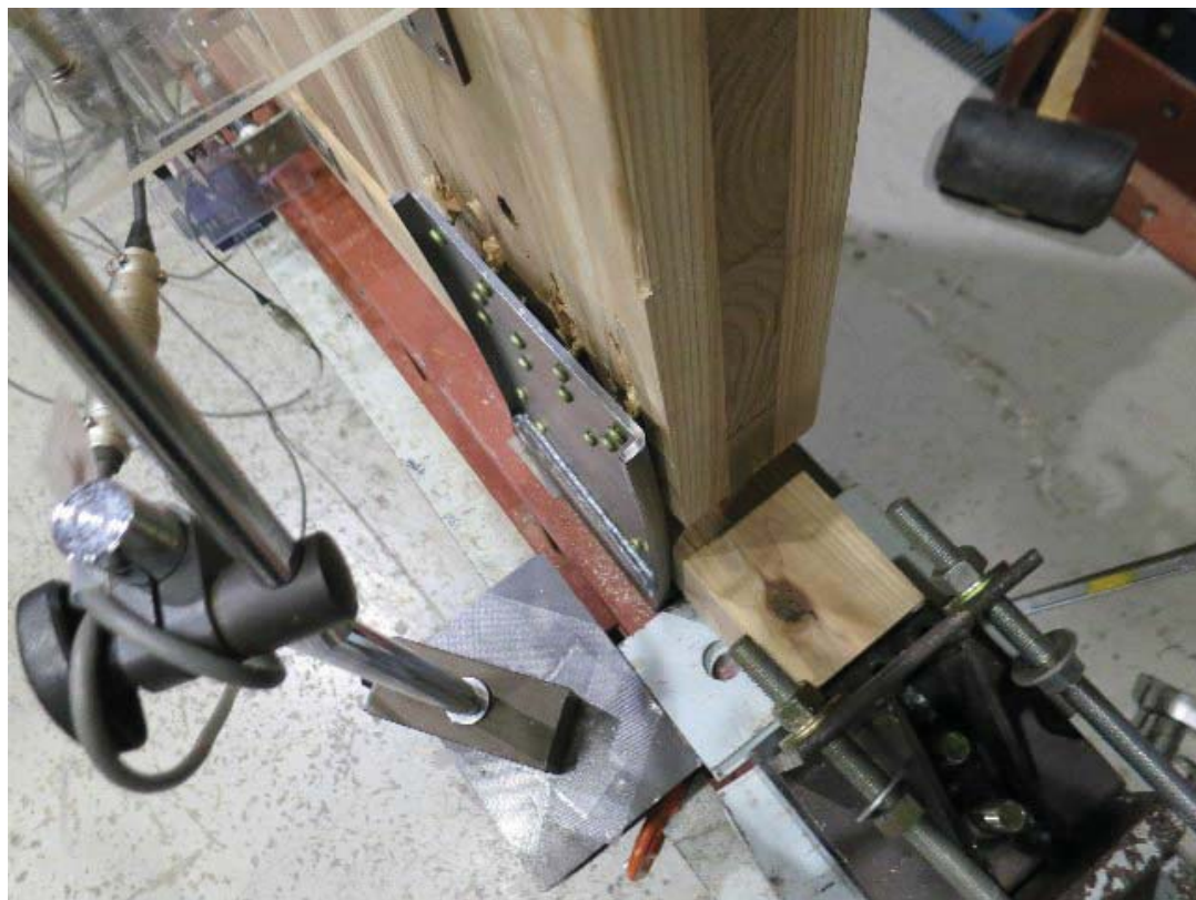
写真 3.2.2.4-24 L型金物のはずれ (L1-2)
