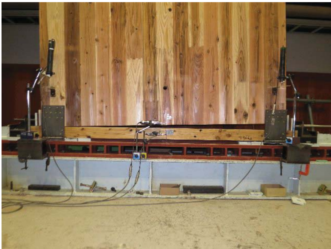
写真 3.2.2.4-31 柱脚部浮き上がりの様子 (L2-1)
