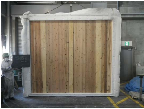
写真 3. 2. 4-29 CLT 載荷壁⑤試験体 (加熱前)
