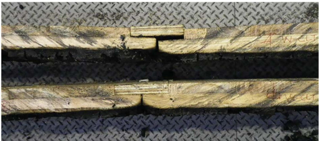
写真 3.2.4-6 CLT 荷壁①試験体(スギ・API 接着剤・ラミナ厚 30mm・5 層) 539kN
