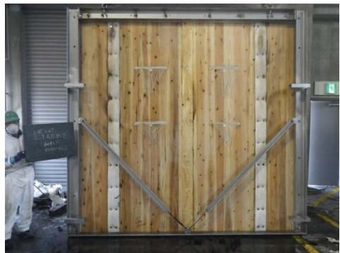
写真 3. 2. 4-18 CLT 載荷壁③試験体 (加熱後)
