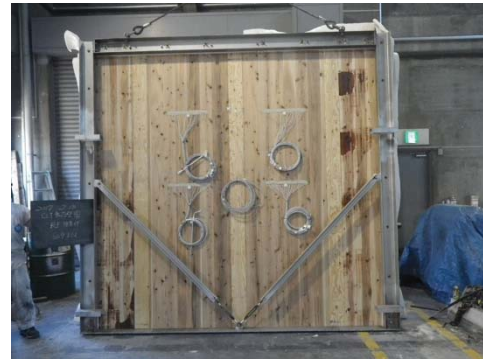
写真 3. 2. 4-23 CLT 載荷壁④試験体 (加熱前)
