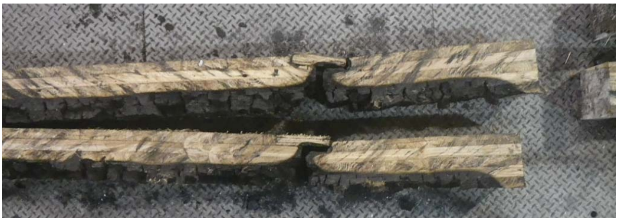
写真 3.2.4-35 CLT 載荷壁⑤試験体(スギ・RF 接着剤・ラミナ厚 30mm・5 層) 402kN
