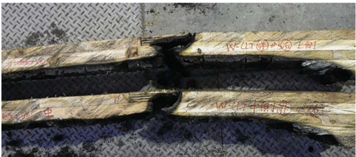
写真 3.2.4-7 CLT 荷壁①試験体(スギ・API 接着剤・ラミナ厚 30mm・5 層) 539kN
