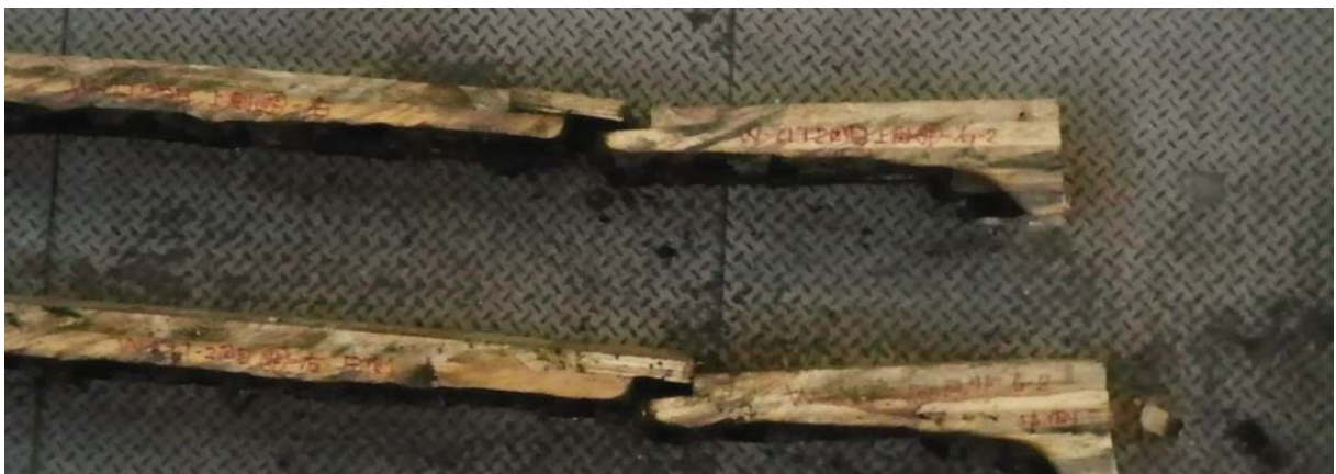
写真 3.2.4-14 CLT 荷重壁②試験体(スギ・API 接着剤・ラミナ厚 30mm・5 層) 603kN
