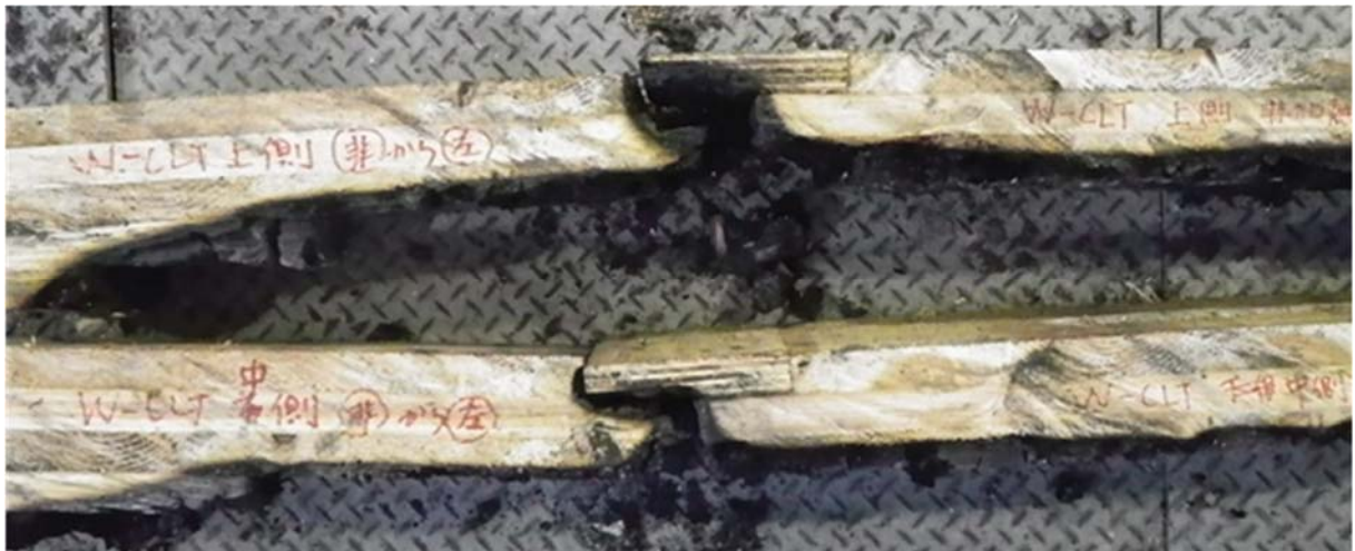
写真 3.2.4-5 CLT 荷壁①試験体(スギ・API 接着剤・ラミナ厚 30mm・5 層) 539kN
