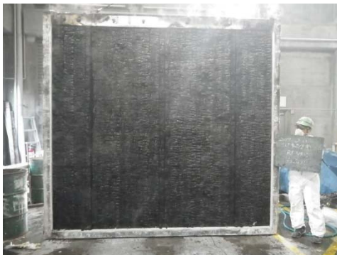
写真 3. 2. 4-24 CLT 載荷壁④試験体 (加熱後)
