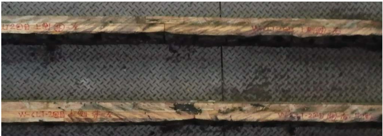
写真 3.2.4-13 CLT 荷重壁②試験体(スギ・API 接着剤・ラミナ厚 30mm・5 層) 603kN
