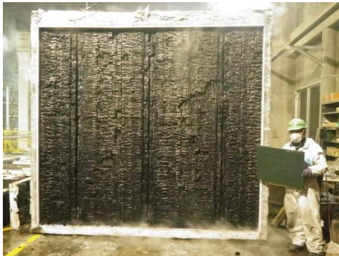
写真 3. 2. 4-31 CLT 載荷壁⑤試験体 (加熱後)
