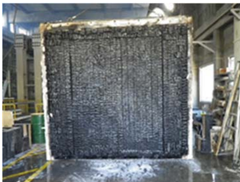
写真 3. 2. 4-3 CLT 載荷壁①試験体 (加熱後)
