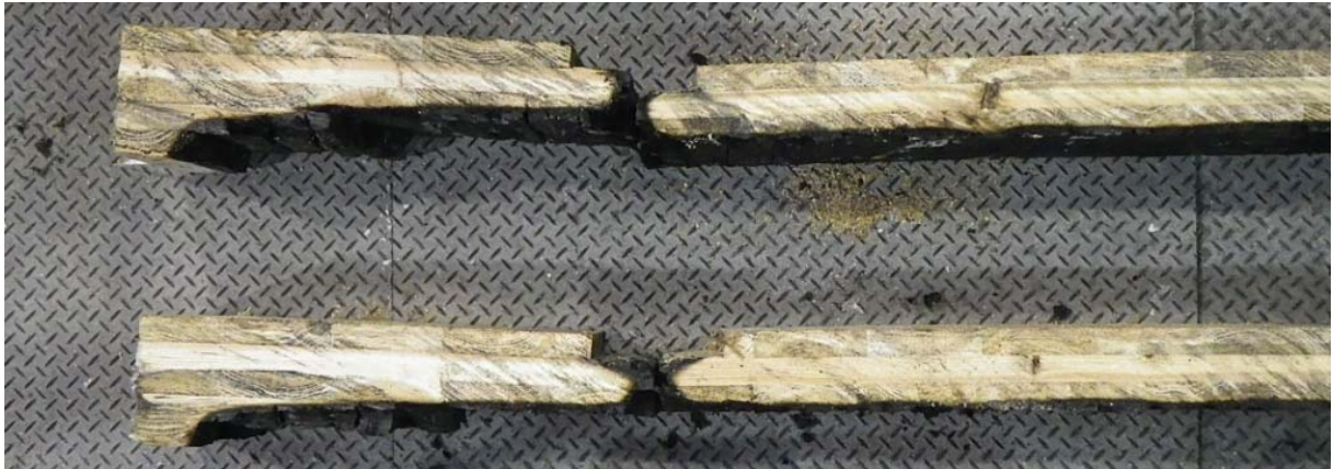
写真 3.2.4-19 CLT 載荷壁③試験体(スギ・API 接着剤・ラミナ厚 30mm・5層) 603kN
