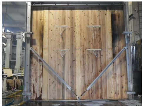
写真 3. 2. 4-25 CLT 載荷壁④試験体 (加熱後)
