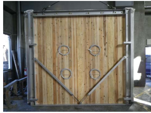
写真 3. 2. 4-9 CLT 載荷壁②試験体 (加熱前)
