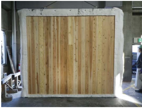
写真 3. 2. 4-8 CLT 載荷壁②試験体 (加熱前)
