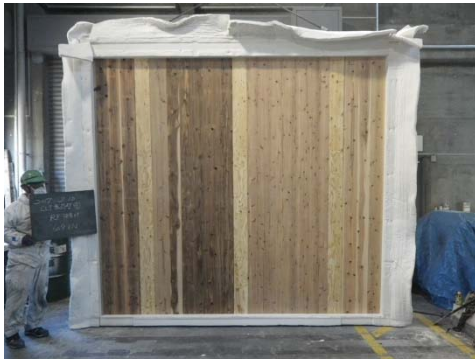
写真 3. 2. 4-22 CLT 載荷壁④試験体 (加熱前)
