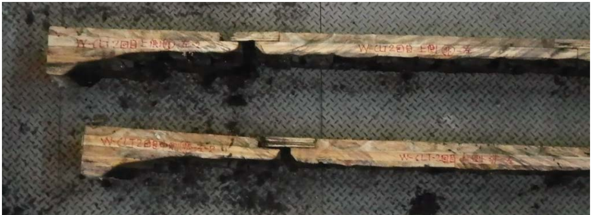
写真 3.2.4-12 CLT 荷重壁②試験体(スギ・API 接着剤・ラミナ厚 30mm・5 層) 603kN
