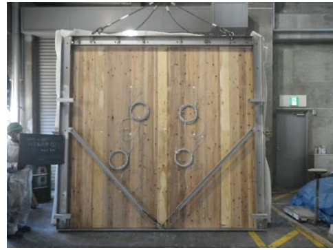
写真 3. 2. 4-30 CLT 載荷壁⑤試験体 (加熱前)
