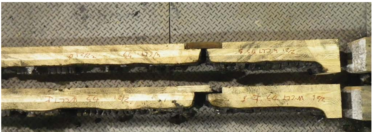
写真 3. 2. 4-42 CLT 载荷壁⑥試験体(カラマツ・API 接着剤・ラミナ厚 30mm・5 層) 603kN
