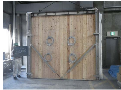
写真 3. 2. 4-37 CLT 載荷壁⑥試験体 (加熱前)
