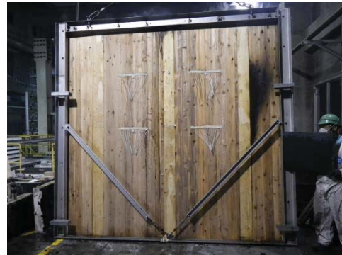
写真 3. 2. 4-32 CLT 載荷壁⑤試験体 (加熱後)
