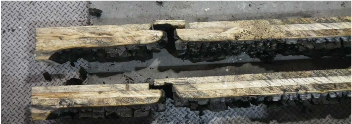
写真 3.2.4-26 CLT 載荷壁④試験体(スギ・RF 接着剤・ラミナ厚 30mm・5 層) 603kN
