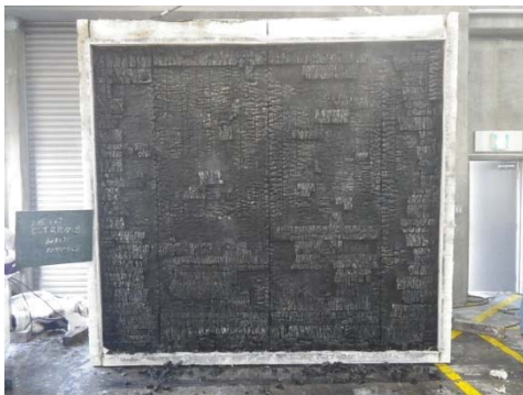
写真 3. 2. 4-17 CLT 載荷壁③試験体 (加熱後)
