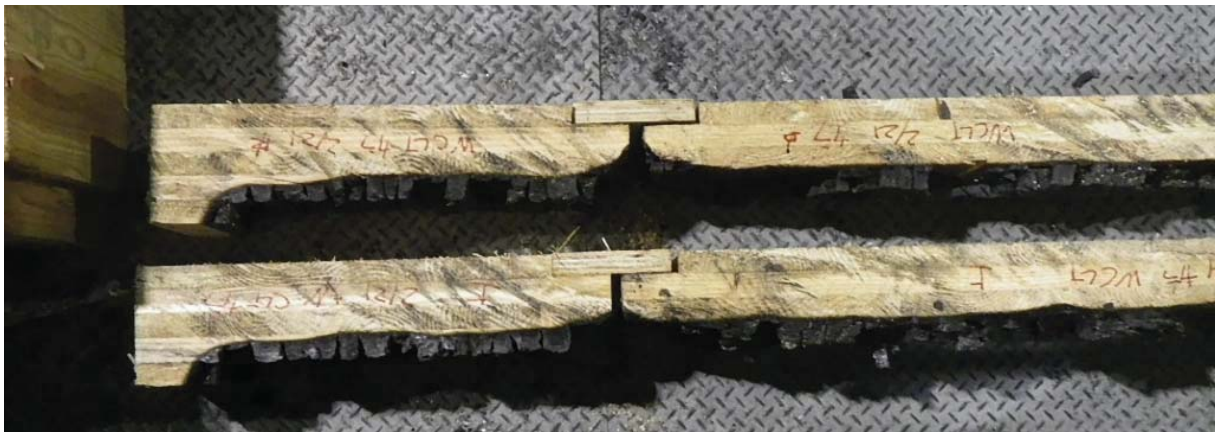
写真 3. 2. 4-40 CLT 载荷壁⑥試験体(カラマツ・API 接着剤・ラミナ厚 30mm・5 層) 603kN
