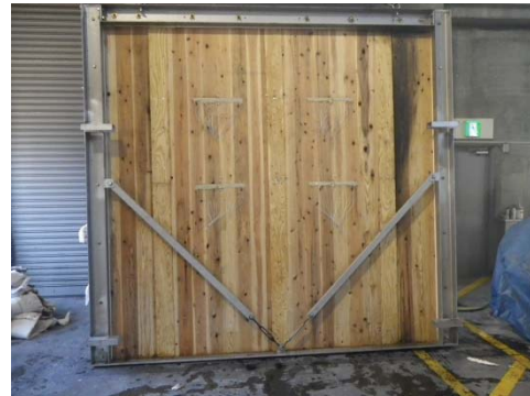
写真 3. 2. 4-11 CLT 載荷壁②試験体 (加熱後)
