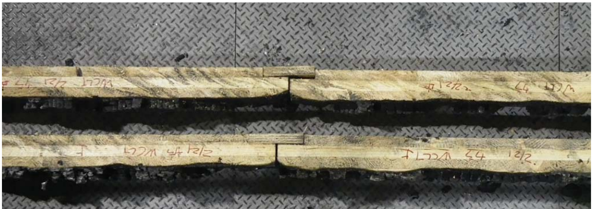
写真 3. 2. 4-41 CLT 载荷壁⑥試験体(カラマツ・API 接着剤・ラミナ厚 30mm・5 層) 603kN
