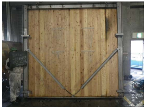
写真 3. 2. 4-39 CLT 載荷壁⑥試験体 (加熱後)
