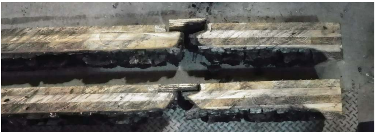
写真 3.2.4-28 CLT 載荷壁④試験体(スギ・RF 接着剤・ラミナ厚 30mm・5 層) 603kN
