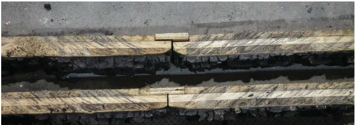
写真 3.2.4-27 CLT 載荷壁④試験体(スギ・RF 接着剤・ラミナ厚 30mm・5 層) 603kN
