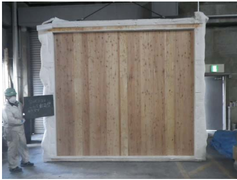
写真 3. 2. 4-36 CLT 載荷壁⑥試験体 (加熱前)
