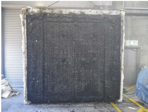
写真 3. 2. 4-10 CLT 載荷壁②試験体 (加熱後)
