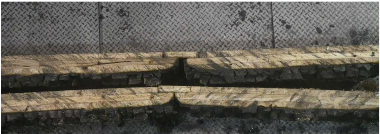
写真 3.2.4-34 CLT 載荷壁⑤試験体(スギ・RF 接着剤・ラミナ厚 30mm・5 層) 402kN
