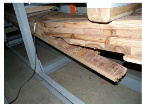
クリープ破壊の様子
