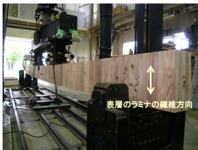
写真3－1 面内曲げ試験(左:強軸方向、右:弱軸方向)
