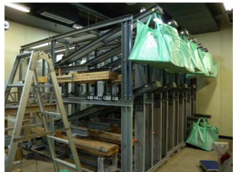
長期荷重載荷試験の様子
