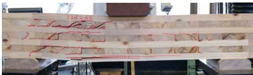
写真4-2 水平せん断式破壊性状(7層7プライ)
