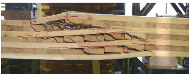
写真4-1 大野式破壊性状(7層7プライ)
