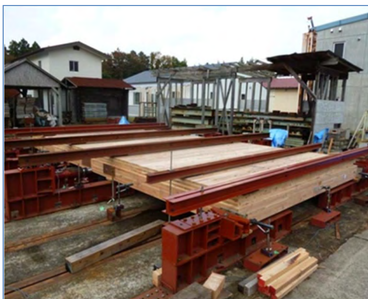
写真3 水平せん断試験の様子
