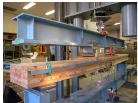
載荷する荷重を求めるために 実施した曲げ試験の様子
